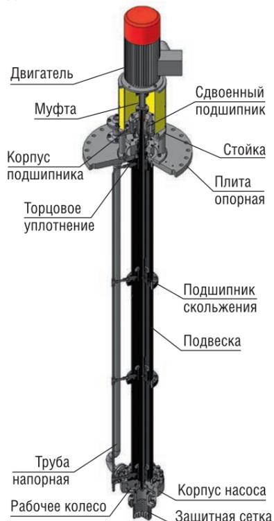
Проточная часть данных насосов соответствует проточной части насосов НКА, в связи с этим основные показатели такие же.
