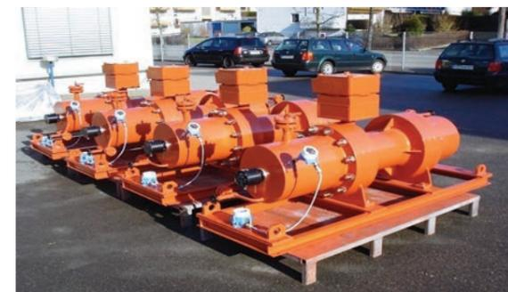
Главное место в номенклатуре выпускаемого насосного оборудования HERMETIC-Pumpen GmbH занимают герметичные бессальниковые центробежные насосы с встроенным экранированным электродвигателем (с защищенным статором) по стандарту API 685, которые из всех типов насосов во всем мире признаны, как наиболее надежные, долговечные и экономичные
