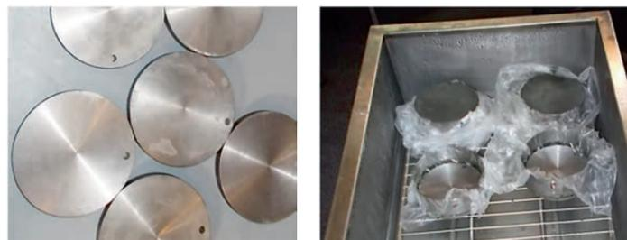
I – металлические диски диаметром 90 мм и толщиной 10 мм с буквенной нумерацией; II – Залитые цементным раствором формы с металлическими дисками и диски подготовленные к заливке
