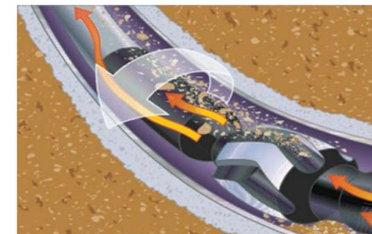
Выполненные на базе ТБТ лопастные элементы представляются достаточно надежными для удаления шламовых подушек и поднятия шлама в область повышенных скоростей циркуляции. В тоже время возникает вопрос об эффективности их работы в случае отсутствия вращения всей бурильной колонны, например, при работе с использованием ГЗД.
