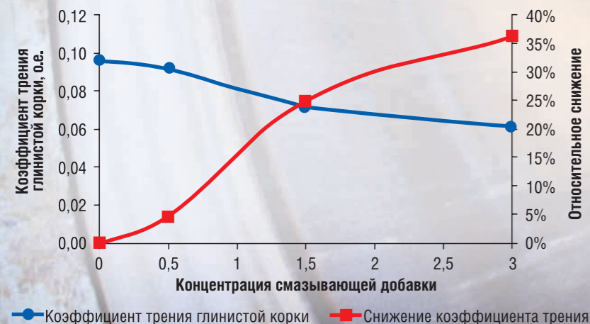
РИС. 6. Влияние концентрации смазывающей добавки FRW на коэффициент трения глинистой корки
