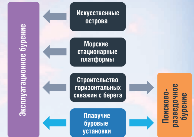
РИСУНОК 3. Вид буровых работ на шельфе в зависимости от места нахождения бурового комплекса
