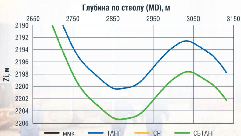
РИС. 1. Сопоставление глубин, рассчитанных по различным методам Zi (м), с глубиной по методу минимальной кривизны Z (м) для горизонтальной скважины № 1
