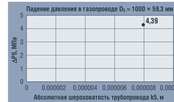
РИС. 6. Зависимость перепадов давлений рассмотренных газопроводов
