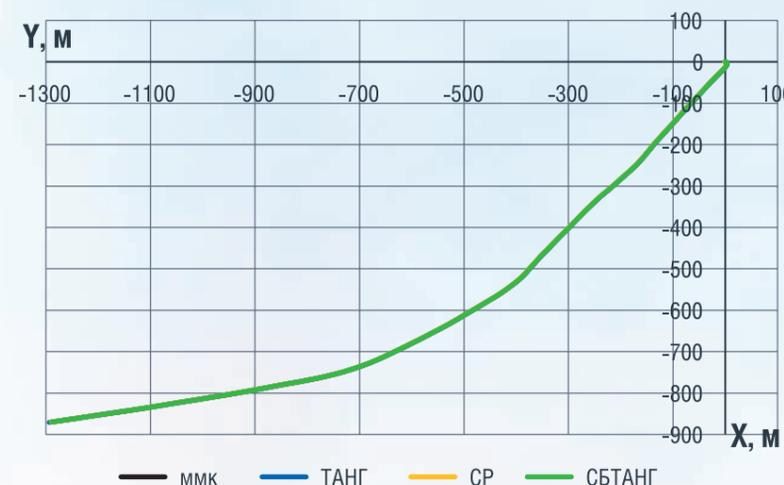
На графике отмечены участки скважины с различными величинами зенитного угла  $I$ . Погрешность расчета по тангенциальному методу в данной скважине значительно возрастает при наборе угла более  $5^\circ$  и достигает 1 м при  $28^\circ$ , а на забое – 4,52 м. В интервалах постоянного зенитного угла погрешность по тангенциальному методу не меняется, а при его падении снижается.
