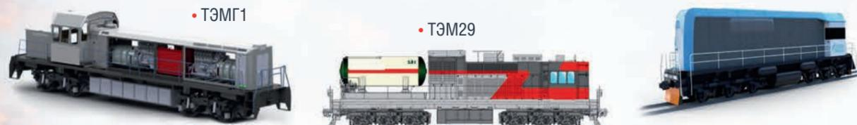
СПГ возможно разместить во второй секции, свободной от размещения силовой установки. При этом использование тендерной секции не требуется, но допустимо с целью увеличения запаса хода данного типажа;
