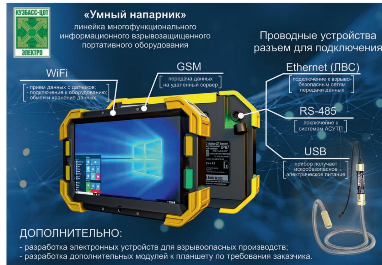
и 0Ex ia IIC T4 X для планшета «Умный Напарник», которые позволяют использовать планшет в условиях постоянного присутствия взрывоопасной атмосферы, существующей как в шахтах, так и на предприятиях, занимающихся добычей и переработкой нефти и газа.
