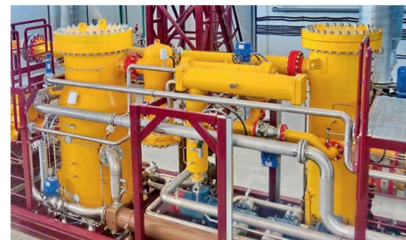
ФОТО 2. Многоступенчатая система сепарации газа, усиленная фильтром-скруббером
