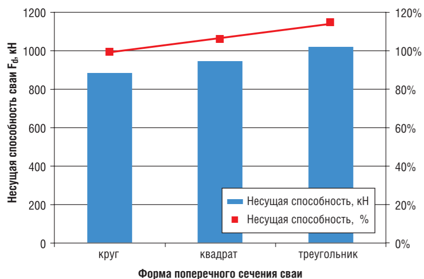
РИС. 2. Влияние формы поперечного сечения вертикально нагруженных висячих забивных свай трения, используемых по принципу II, на их несущую способность по грунту основания
