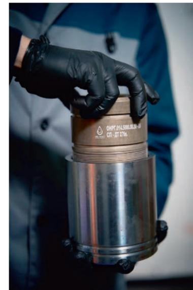
После растворения в скважине остается только фрагмент защитного покрытия, легко разрушаемого в ходе проведения СПО. Это исключает необходимость разбуривания, закачки спецжидкостей или дополнительных технологических операций, обеспечивая непрерывность и безопасность процесса.
