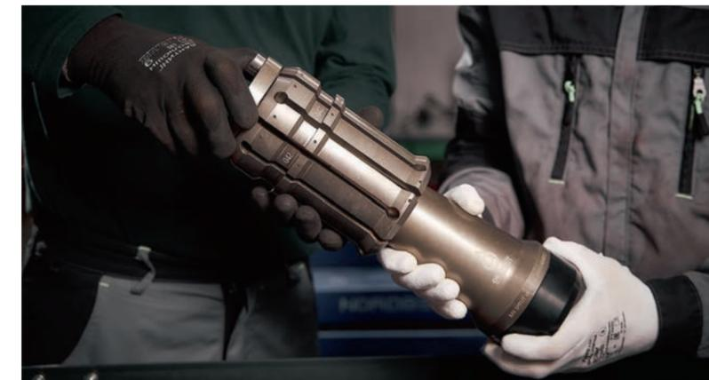
РИСУНОК 9. Посадка ключа-пробки
