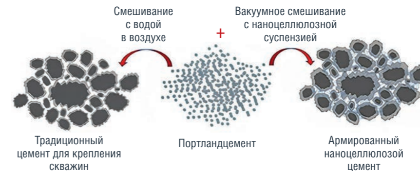
РИСУНОК 7. Укрепление цемента для крепления скважин наноцеллюлозой
