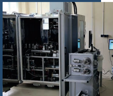
РИСУНОК 6 Установка для оценки влияния технологических жидкостей на фильтрационные свойства призабойной зоны пласта
