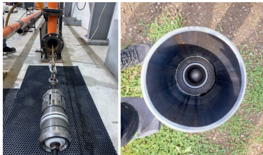
РИСУНОК 4. Стендовые испытания пакер-пробки MEDUSA-114
