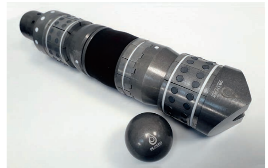
РИСУНОК 1. Первый опытный экземпляр Ойл Энерджи растворимой пакер-пробки Plug'n'Perf
