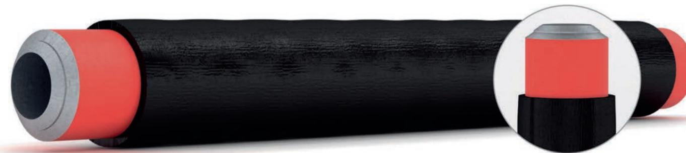
Металлопластмассовые трубы и патрубки диаметром до 325 мм с максимальной толщиной стенки 20 мм представляют собой стальную трубу, патрубков с наружным полиэтиленовым (для подземной прокладки) или лакокрасочным покрытием (надземная прокладка), футерованные внутри полиэтиленовой трубой (оболочкой) и закрепленные наколочниками из:
