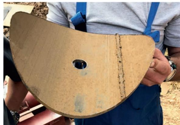
Для определения достоверности разработанной методики расчета металлической стружки проведена тестовая врезка на трубе диаметром 325 мм с толщиной стенки 10 мм кольцевой фрезой диаметром 292,1 мм с толщиной стенки 9,5 мм и сверлом диаметром 34 мм (рисунок 2).
