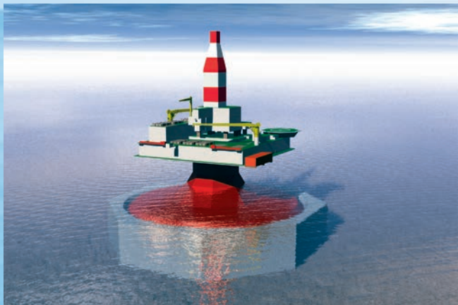
РИС. 7. ЛПБУ для круглогодичного разведочного бурения
