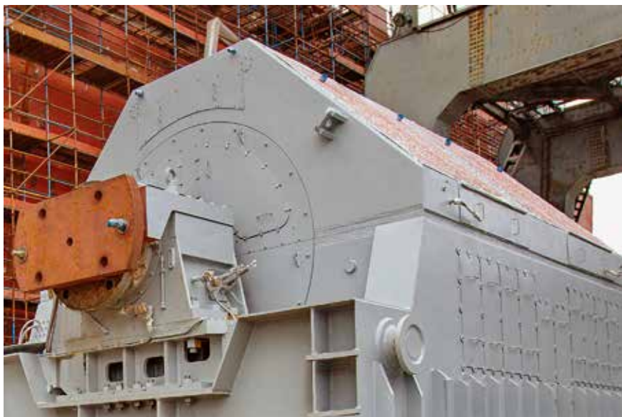
Уникальный гребной электродвигатель для проекта 22220
