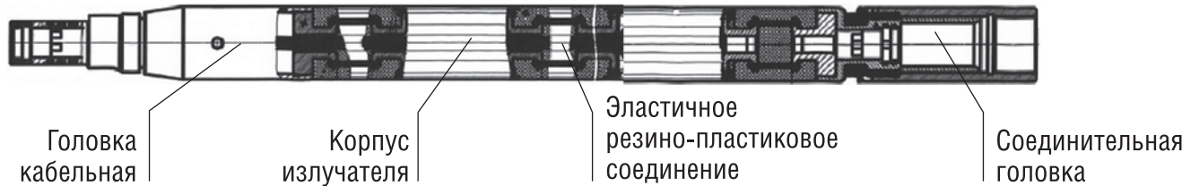
РИС. 2. Конструктивная схема скважинного акустического прибора
