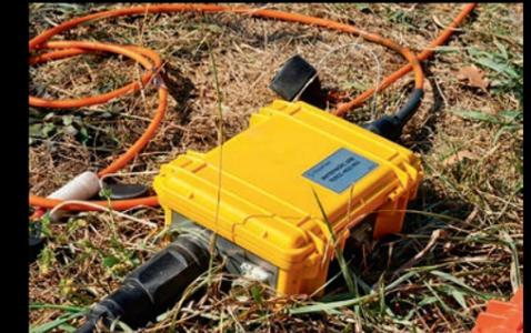
Станция предназначена для производства сейсморазведочных работ методами преломленных и отраженных волн при проведении геолого-геофизических исследований.
