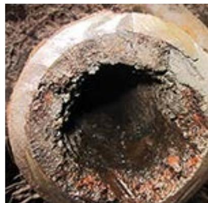
ФОТО 3. Коррозия газопровода
