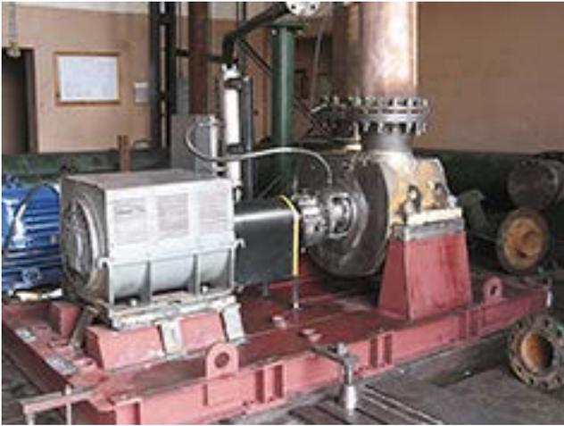
РИС. 3. Насосный агрегат АНДг 500-100 на испытательном стенде
