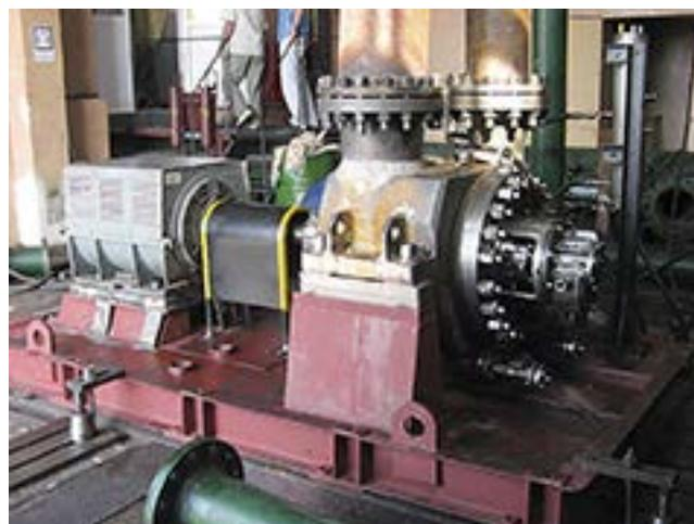
РИС. 2. Насосный агрегат АНДг 1300-125 перед проведением испытаний
