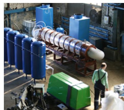
РИС. 2. Полноразмерная модель реактора БКУ с обвязкой
