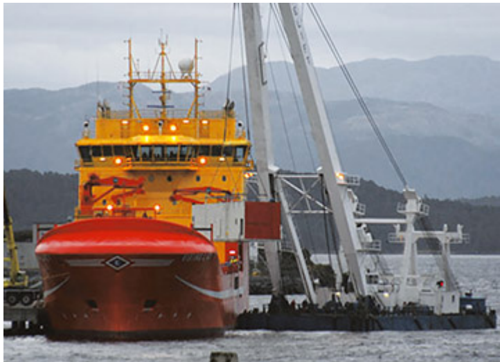
Опытное норвежское судно Viking Lady с вспомогательной ЭУ с ТЭ мощностью установки 320 кВт
