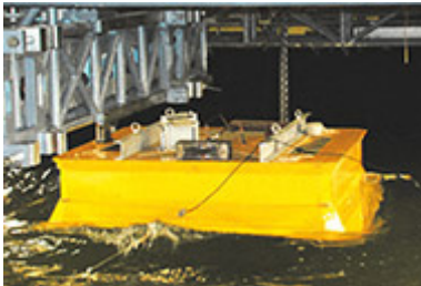
Буксировочные испытания модели в условиях глубокой воды и регулярного волнения
