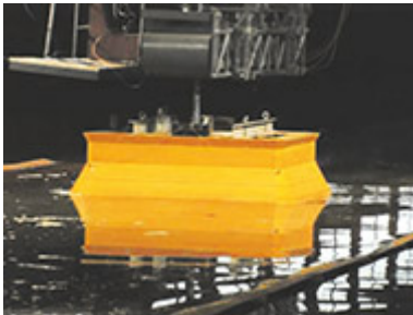
Буксировочные испытания модели в условиях мелководья (9,4 м)
