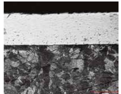
Из анализа структуры следует, что покрытие характеризуется низкой пористостью 0,5–0,7%.
