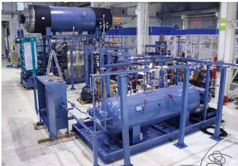
РИС. 3. Сборка блочно-модульной холодильной машины GEA, Климовск, Цех №1
