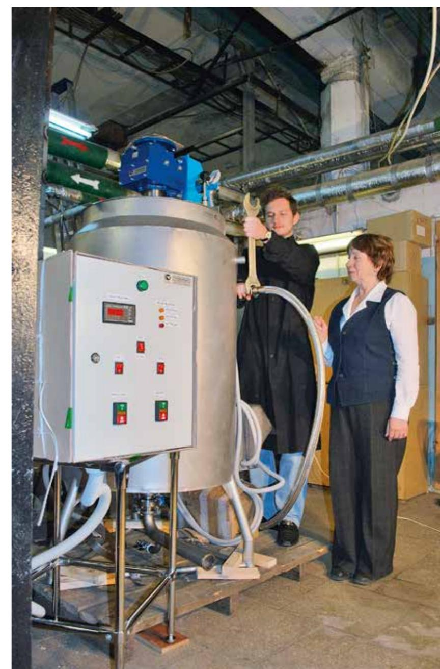
РИС. 2. На участке сборки оборудования предприятия ИТП «ПРОМБИОФИТ»: подготовка к испытаниям установки УПЭС-0.6/7.5, предназначенной для оснащения производства минеральных удобрений
