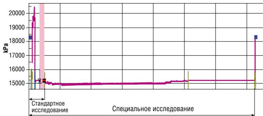
РИС. 7. График изменения давления в процессе исследования скважины 9 Р методом ГДК (глубина 1420,6 м)
