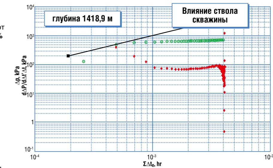
РИС. 3. График изменения давления в нефтенасыщенных (1) и водонасыщенных (2) отложениях неокомского надъяруса скважины 9 Р (по материалам ГДК)
