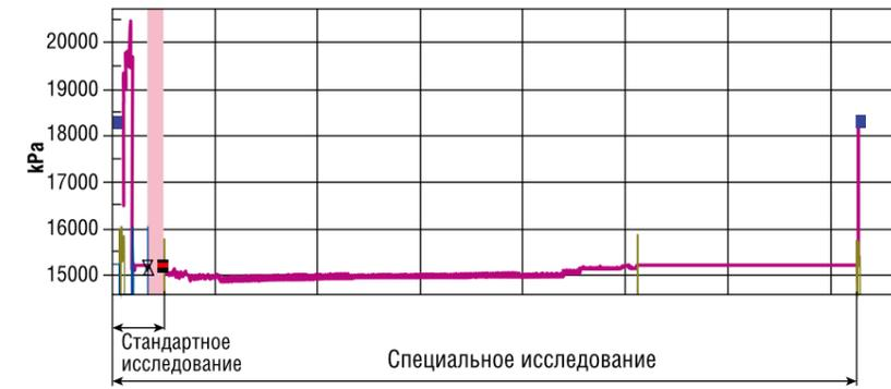
РИС. 7. График изменения давления в процессе исследования скважины 9 Р методом ГДК (глубина 1420,6 м)
