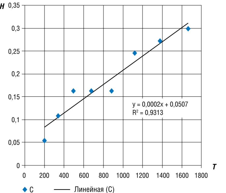
РИС. 6. Зависимость скорости всплытия и от подогрева жидкости
