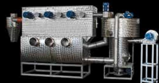
Комплекс предназначен для отмычки и сушки полимерного сырья со средними типами загрязнений: земля, грязь, песок, и т.д. Дополнительно можно добавлять, в бак оборотной воды, реагенты и моющие средства для очистки сырья от жира, масла, удаления запаха и т.п. Так же в комплекс встроен агрегат мини-флотации, для удаления металлических и т.п. инородных предметов.
