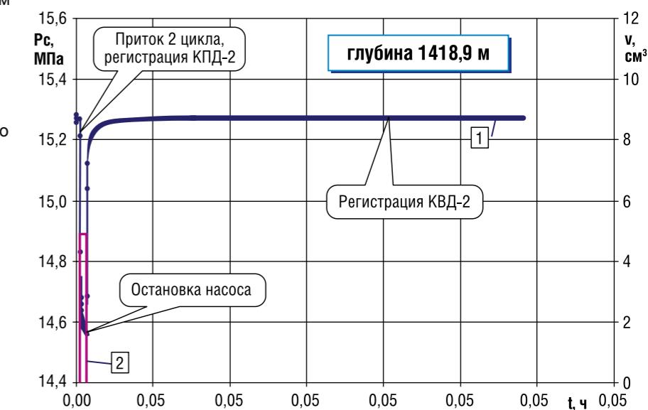
РИС. 2. Диагностический билогарифмический график КВД 2 по скважине 9Р (глубина 1418,9 м)
