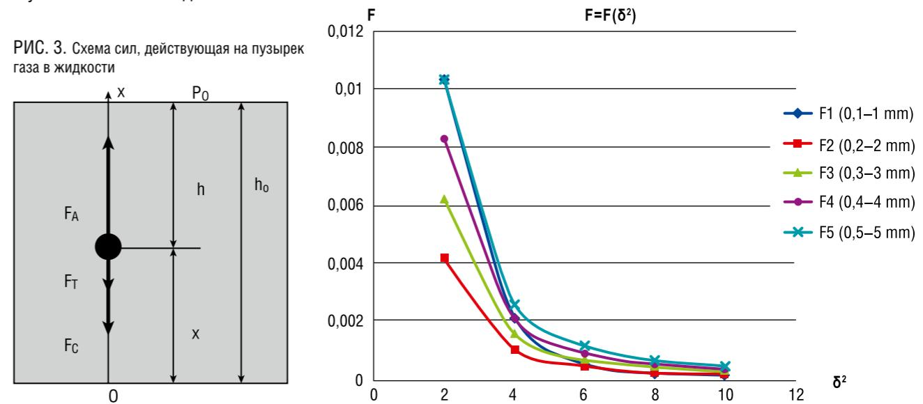
РИС. 3. Схема сил, действующих на пузырек газа в жидкости
