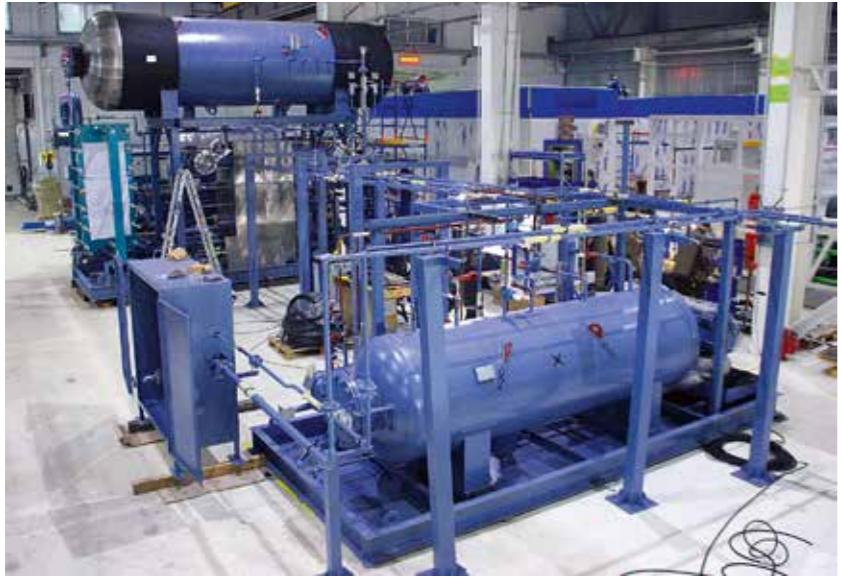
РИС. 3. Сборка блочно-модульной холодильной машины GEA, Климовск, Цех №1
