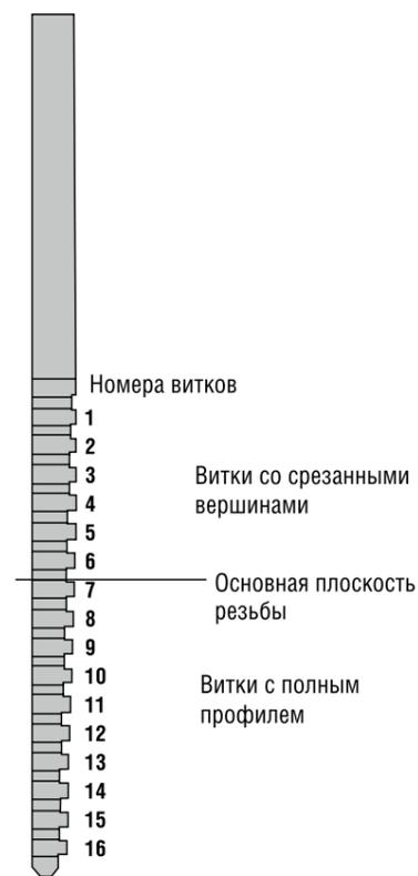
стандартной муфты, навинченной на трубу с натягом три витка. На последующих рисунках будем изображать только поверхности сопрягаемых деталей, попавших в сечение продольной плоскостью (рис. 2)
