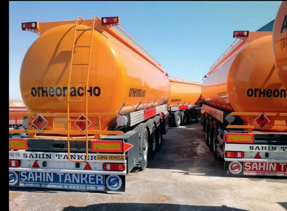
Тип подвески, количество осей, производитель односкатная, пневматическая 3 оси, BPW, 3x9 тонн передняя подъемная ось
