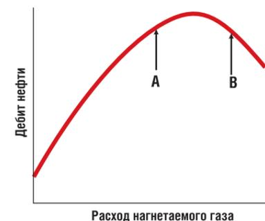
Задача состоит в том, чтобы определить истинную форму кривой для выяснения идеального распределения дополнительного газа. Какая из скважин демонстрирует самый крутой градиент при выделении ей фиксированного объема газа? После того, как это определено, следующий вопрос – какое количество газа имеется для распределения между скважинами?
