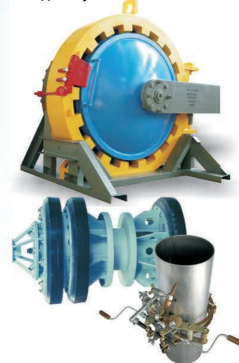
В 2010 году освоен выпуск затвора быстродействующего байонетного типа ШРК предназначенного для камер запуска/приёма внутритрубных устройств, служащих для обслуживания газо- и нефтепроводов с условным проходом DN1400 и рабочим давлением PN8,0 МПа. Данный затвор запатентован в «Роспатент» и изготавливается по конструкторской документации ООО «УралКомплектСервис» на производственных мощностях ФГУП «Комбинат «Электрохимприбор».
