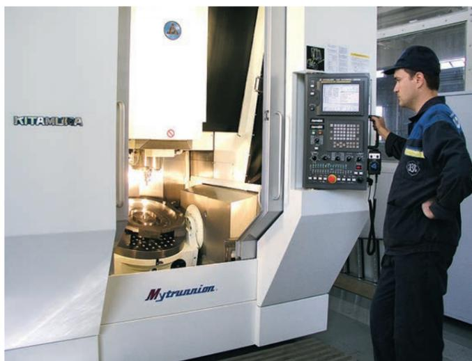
Завод имеет возможность выпуска любой инструментальной продукции с точностью обработки до 2 мкм из заготовок весом до 8000 кг, максимальными габаритами 2600x2250 мм и любой сложности обрабатываемого контура.
