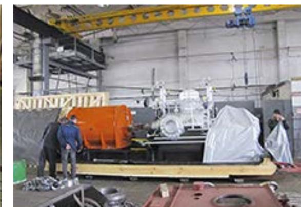
РИС. 14. Насосный агрегат АНДМг 600-320 перед отгрузкой в ЗАО «РНПК»
