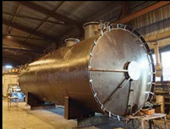
Горизонтальные подземные дренажные емкости (ЕПП и ЕП) используются на автозаправочных станциях для слива топлива в случае возникновения аварийных ситуаций. Помимо этого, емкости класса ЕП могут использоваться на промышленных предприятиях для сбора жидких отходов (включая воду) из трубопроводных сетей.
