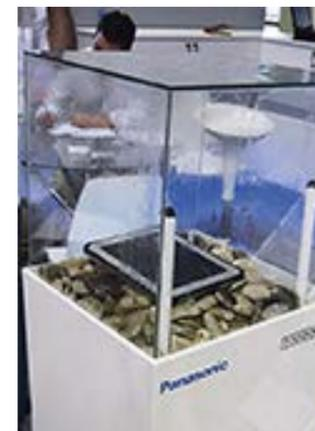
Наиболее яркая модель защищенного ноутбука, которая представлена на стенде – Ноутбук Panasonic стандарта IP-65 – полностью защищенный современный планшет с ОС Windows 8 и промышленным портом RS-236. Этот порт один из наиболее распространенных в промышленности и он отсутствует на простых ноутбуках.
