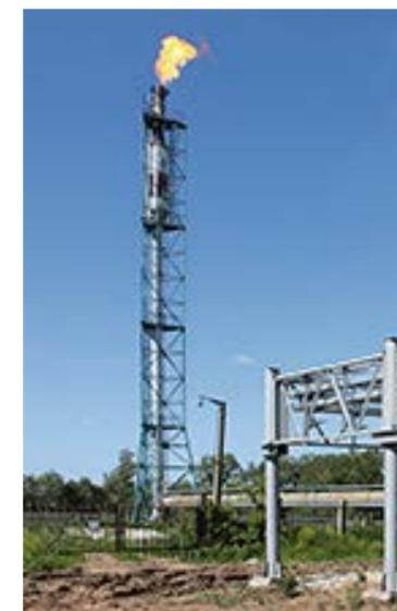
РИС. 3. Сжигание аммиака в факельной установке
