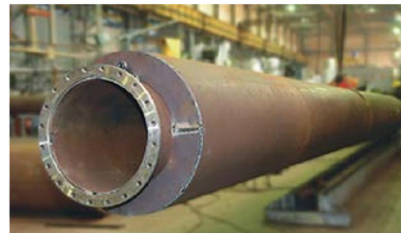
термокейсы – запатентованная технология тюменского завода «Сибпромкомплект» – одного из ведущих российских производителей трубопроводов в заводской изоляции. Термокейс «Сибпромкомплект» – это обсадная колонна, которая изготавливается из стальных труб по технологии «труба в трубе» с заливкой межтрубного пространства пенополиуретаном.
