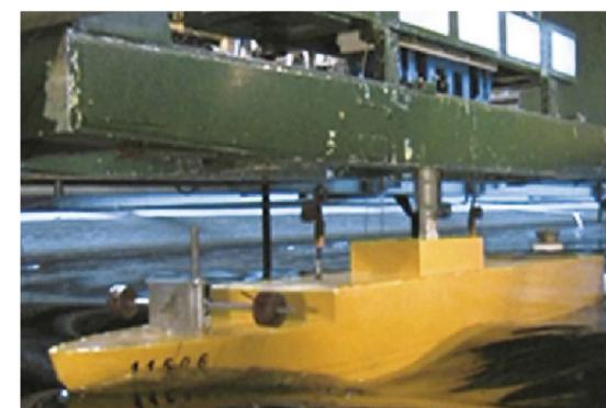
Испытания модели морского ТУС на нерегулярном волнении
