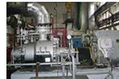
РИС. 11. Насосный агрегат АНДМг 600-320 в цехе аммиака ОАО «РВНОАЗОТ»
