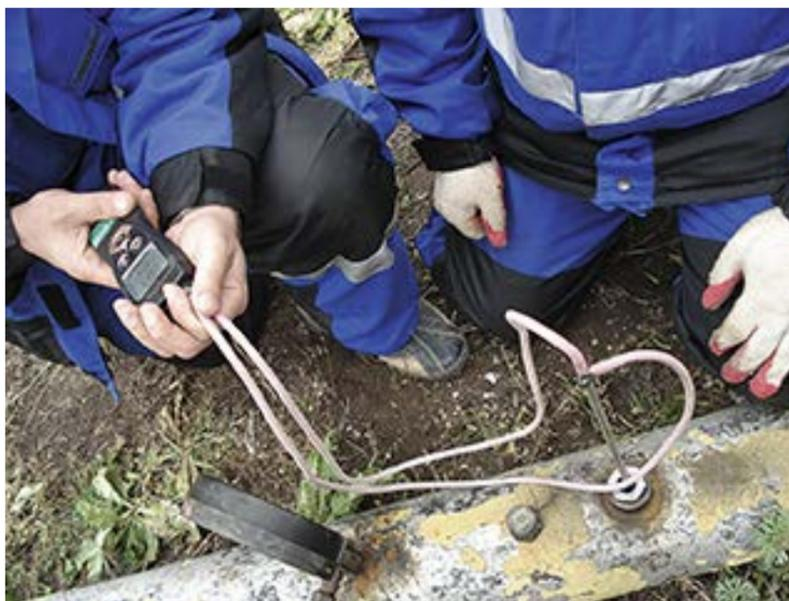
ФОТО 1. Определение расхода попутного газа
