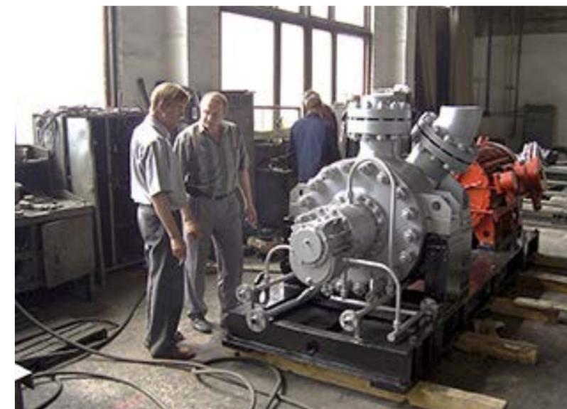
РИС. 9. Насосный агрегат АНДМг 360-350 перед отгрузкой на объект
