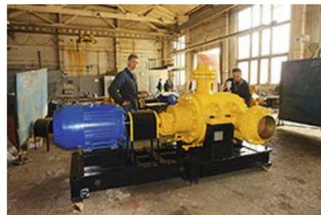
РИС. 5. Насос НДг 300-100 перед отгрузкой на объект
