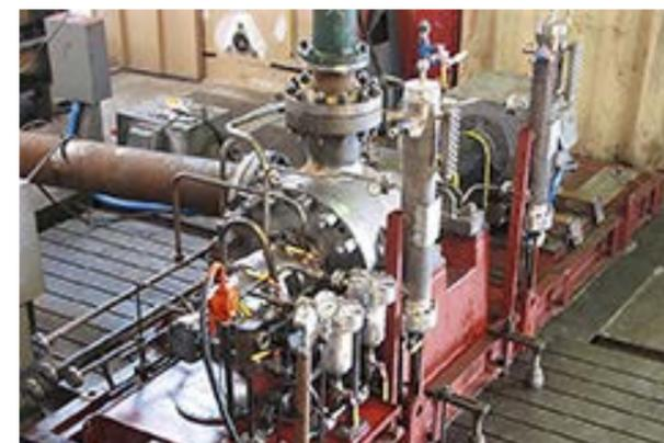
РИС. 13. Насосный агрегат АНДМг 600-320 для ЗАО «РНПК» в испытательной лаборатории ООО «СМЗ»
