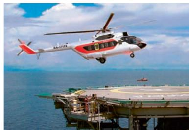
Он предназначен для полета над акваториями на удаленные от берега буровые платформы, а также для поисковых и спасательных морских операций. Максимальный взлетный вес машины – 13 т, вместимость – до 24 человек, комплекс бортового оборудования позволяет выполнять полеты
