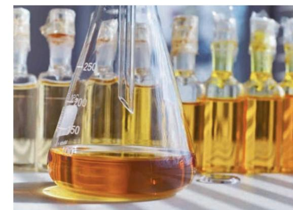
Дизельное топливо (рис. 2) – это нефтяная фракция, основу которой составляют углеводороды с температурами кипения 200...350 °С. Выглядит ДТ как более вязкая, чем бензин, прозрачная жидкость желтого или светло-коричневого цвета в зависимости от содержания смол.
