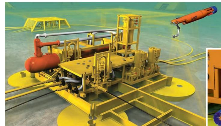
РИС. 1. Концепт-проект СПбГМТУ и «Океанос» АНПА с манипуляторным комплексом (на рис. представлена для примера устьевая донная арматура FMC Technologies)
