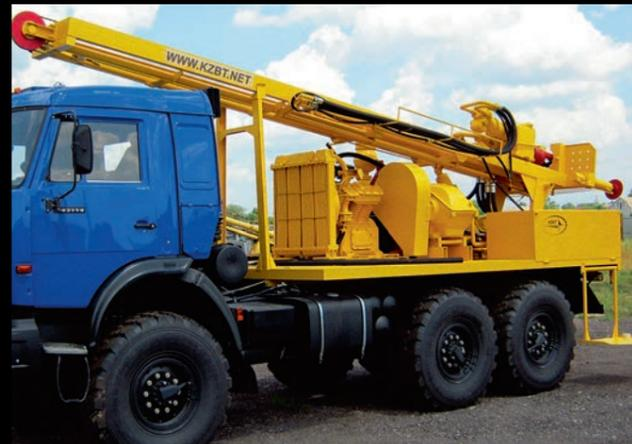
Буровые установки серии УГБ для ведения геологоразведочных работ.
