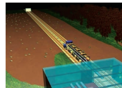
РИС. 6. Работы по укладке трубопровода на композитные понтоны
