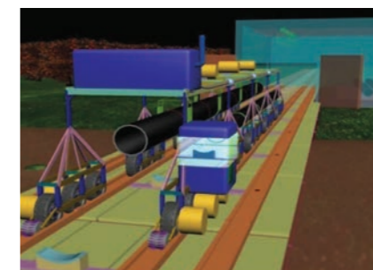
РИС. 7. Укладка трубопровода на понтоны с помощью автоматизированного трубоукладчика
