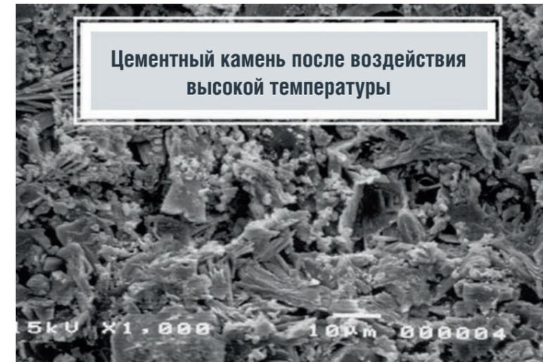
Превращение после температуры 110°C гидросиликата C-S-H(II) в высокоосновный гидросиликат кальция, кристаллизующийся в виде продуктов большого размера и образующийся в форме пластин в цементном камне, ослабляет его прочность из-за низкой прочности контактов. При этом возникает структура, обладающая относительно высокой проницаемостью.
