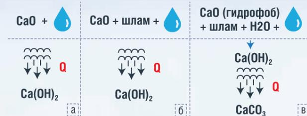
РИС. 3. Разница процессов введения реагентной добавки для сухого и влажного отходов
