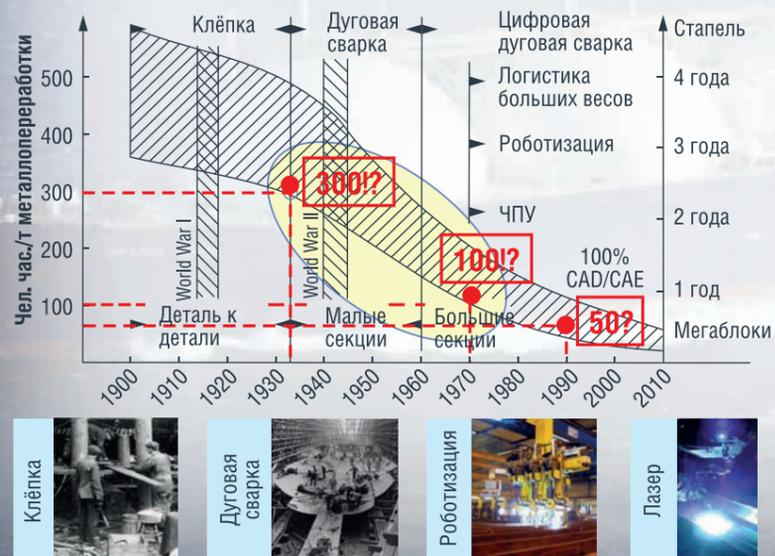
РИС. 2. Производительность труда в мировом судостроении по данным IMG GmbH
