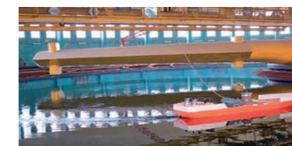
РИС. 15. Фрагмент испытаний моделей в циркуляционном бассейне
