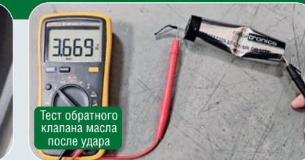
После испытания не наблюдалось разрушений, утечек или возгорания
