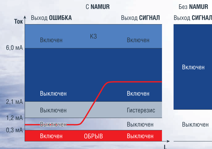
РИСУНОК 3. Состояние выходных сигналов и индикации при работе с сигналами NAMUR
