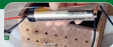
Настройки испытания на короткое замыкание
