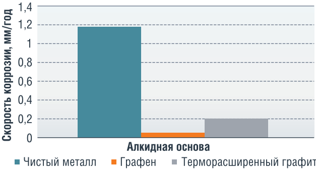
РИСУНОК 6. Скорость коррозии при переменном смачивании
