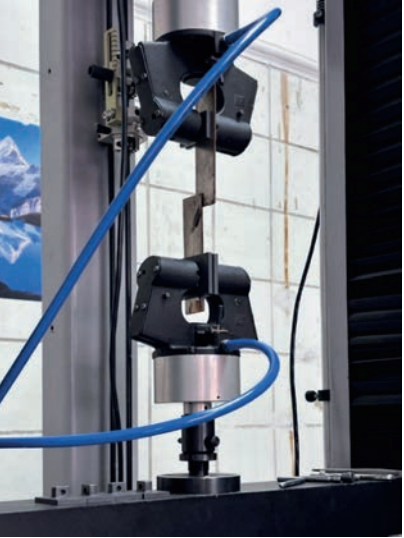
РИСУНОК 3. Определение адгезионной прочности соединений
