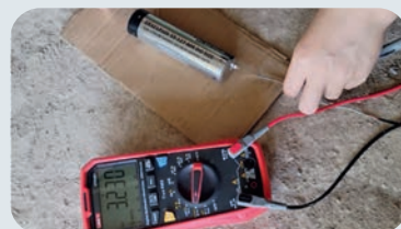
После короткого замыкания: нет деформации, нет утечки, нет взрыва
