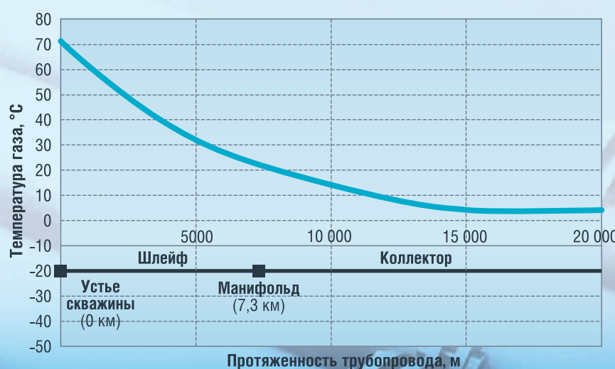
РИСУНОК 3. Распределение температуры потока по трассе промысловых трубопроводов на Киринском ГКМ
