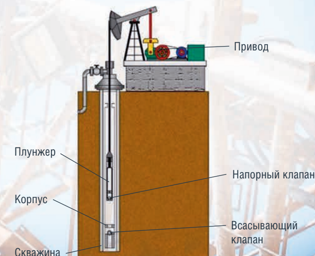
РИСУНОК 1. Принципиальная схема ШГН
