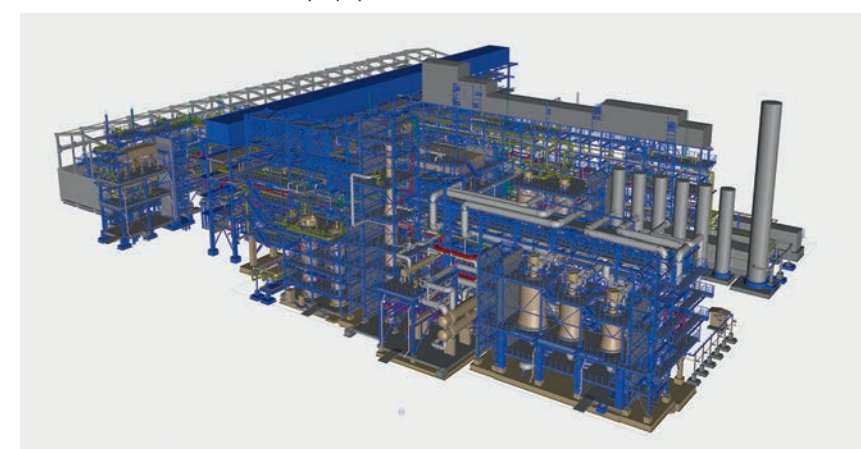
РИСУНОК 2. Каталитический риформинг бензинов
