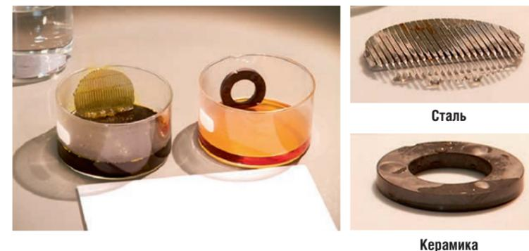
концентрированных азотной и соляной кислот. Через 30 минут стальные пластины практически полностью растворились в смеси кислот. Керамические пластины не подверглись коррозии, остались в исходном состоянии.
