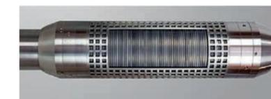
Более подробно применение инновационной конструкции песчаного фильтра описано в статье SPE "166092 Ceramic Screens – An Innovative Downhole Sand Control Solution for Old & Challenging Cased Hole Completions".
