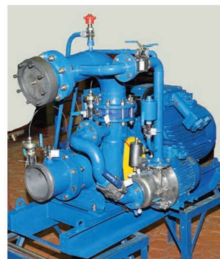
Насосная установка УОДН 300-200-150 с элементами самовсасывания
