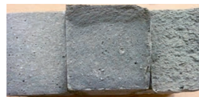
РИСУНОК 6. Скол цементного камня с добавлением доменного шлака (слева направо составы ПЦТ/шлак 60/40, 50/50, 100/0) после 30 суток нахождения в водяной бане при температуре 100°С
