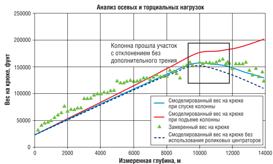
РИС. 2. Графическое отображение осевых и торсионных нагрузок по результатам моделирования программы расстановки центраторов
