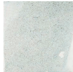
РИС. 4. Шлиф исследуемого образца – песчаника
