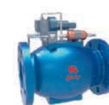
Клапан сброса давления при гидроударе серии HTSJ (сертифицирован Saudi Aramco) Размеры: 1"–16" Диапазон давления: 150–900 фунтов Диапазон температур: -40° C~+320° C
