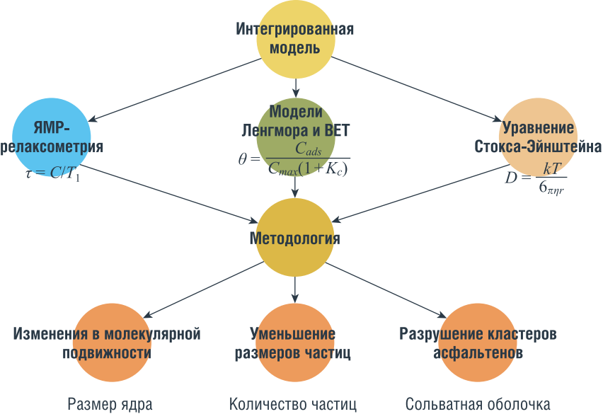
РИСУНОК 2. Схема интегрированной модели расчета размеров асфальтенов под воздействием акустических волн
