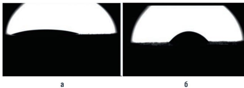
РИСУНОК 2. Фотографии шлама под автоматическим тензиометром IFT-820-р: а – без добавления ингибитора (капля смачивает шлам); б – с обработкой ингибитора (глина инкапсулирована)
