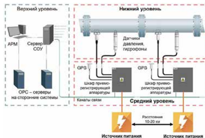
РИС. 3. Структурная схема СОУ нефти
