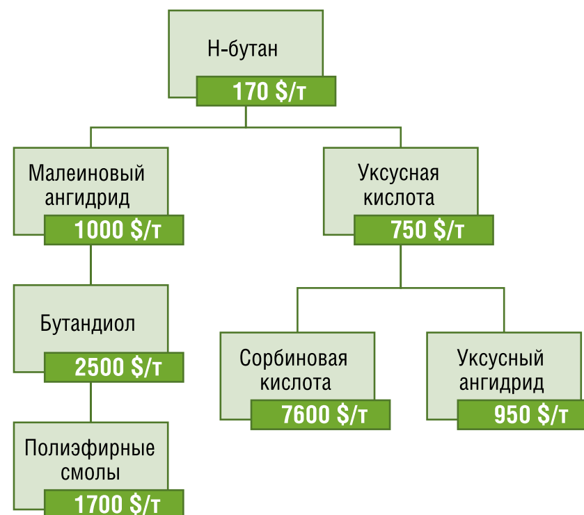
РИС. 5. Принципиальная схема получения продуктов из н-бутана
