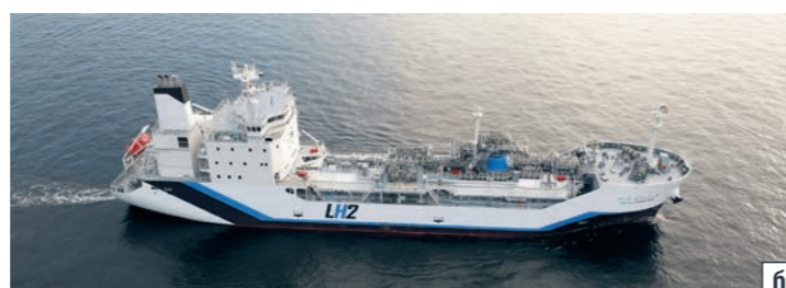
РИСУНОК 4. Способы транспортировки жидкого водорода: (а) – цистерна ППЦ-45/1,0 для жидкого водорода производства АО «Криогенмаш»; (б) – Suiso Frontier – первое в мире судно для перевозки сжиженного водорода
