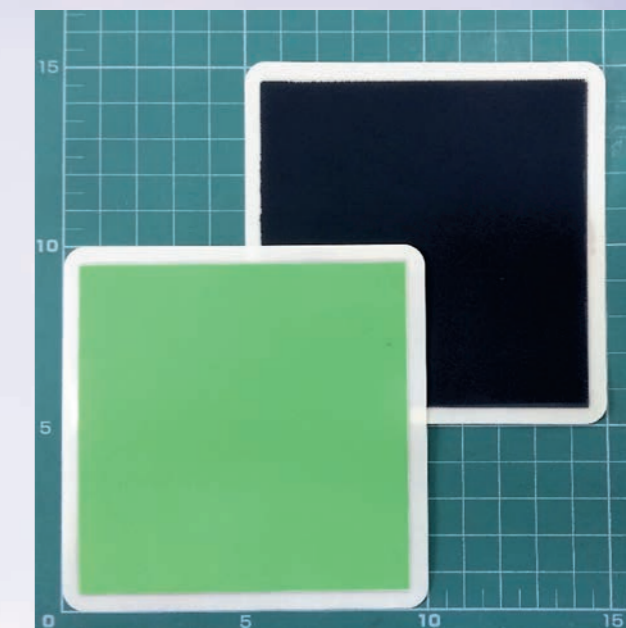
РИСУНОК 2. Фотография единичных ТОЭлЭ размером 100×100 мм, изготовленных в ИФТТ РАН
