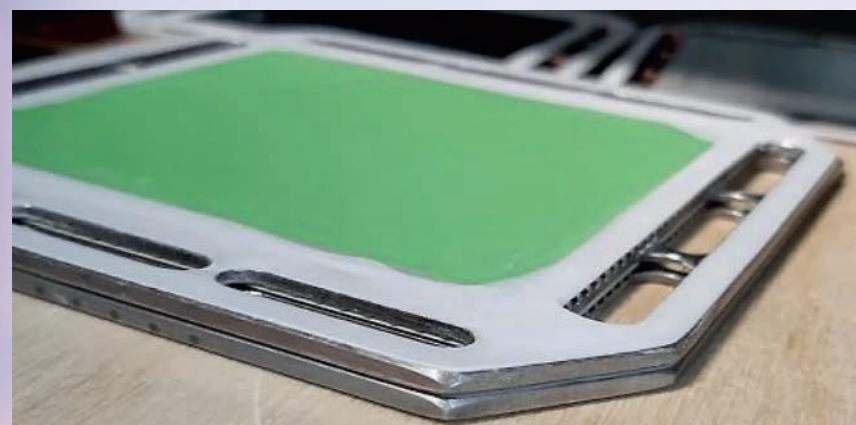
РИСУНОК 4. Повторяющиеся элементы блока ТОЭлЭ: биполярный токовый коллектор с вклеенным с помощью специального контактного состава единичным ТОЭлЭ, а также с нанесенным по периметру высокотемпературным стеклогерметиком
