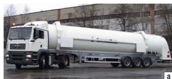
РИСУНОК 4. Способы транспортировки жидкого водорода: (а) – цистерна ППЦ-45/1,0 для жидкого водорода производства АО «Криогенмаш»; (б) – Suiso Frontier – первое в мире судно для перевозки сжиженного водорода
