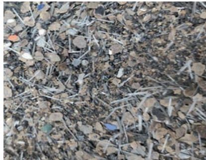
РИСУНОК 5. Разнофракционный состав колюматанта
