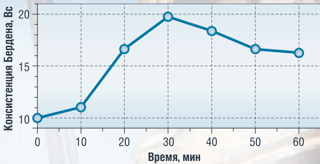
РИСУНОК 3. Изменение консистенции опытного образца, при температуре 30–35 °C
