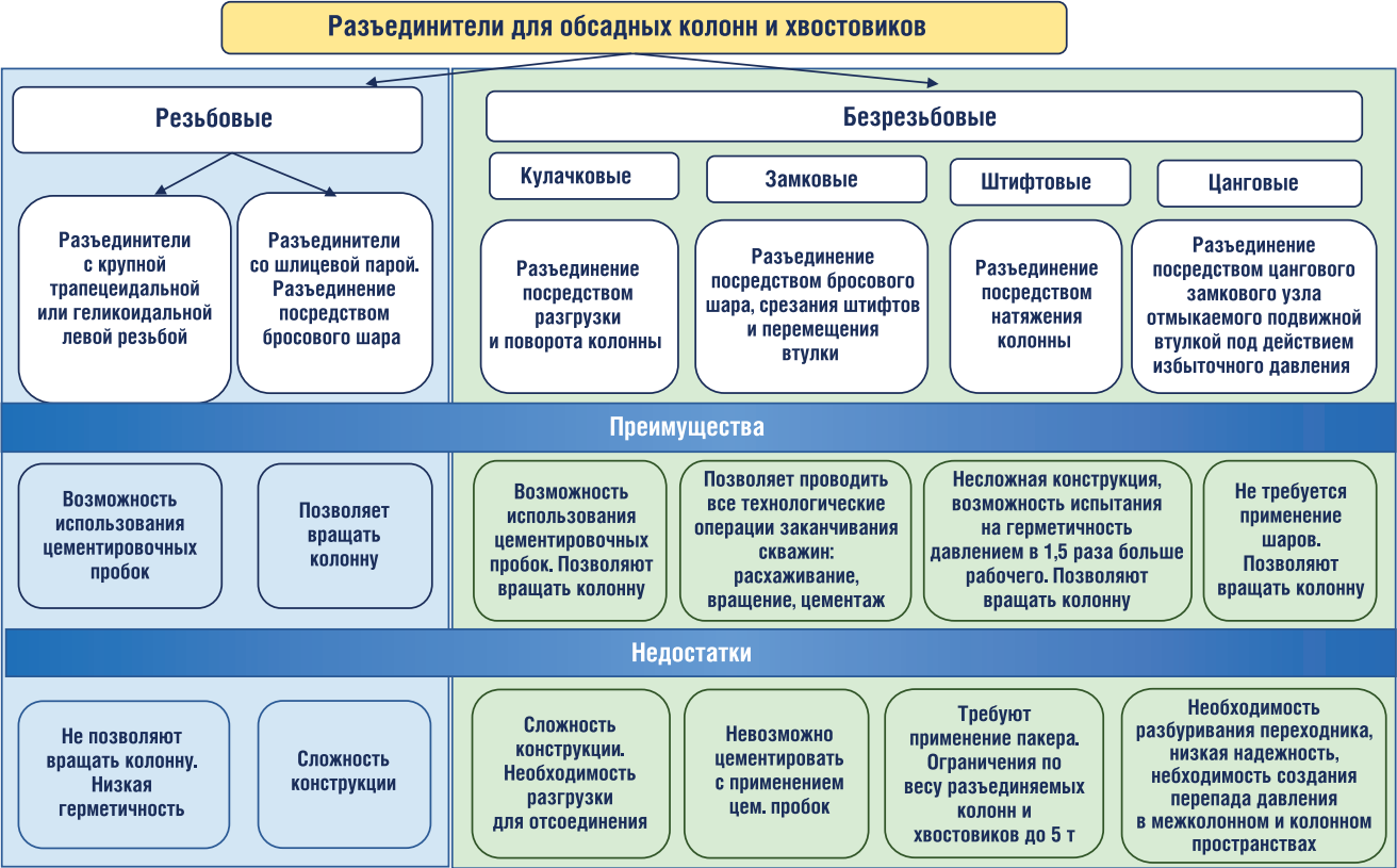
РИСУНОК 2. Классификация разъединителей для обсадных колонн и хвостовиков. Преимущества и недостатки
