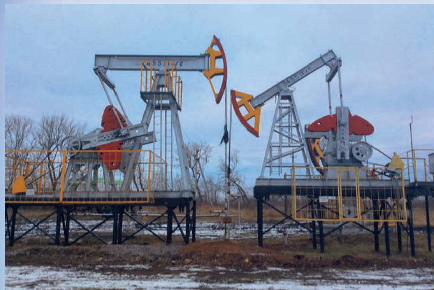
РИСУНОК 1. Двухлифтовая УСШН на скважине
