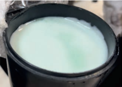
РИСУНОК 2. Внешний вид состава плотностью 0,90 г/см³ после отстоя 48 ч
