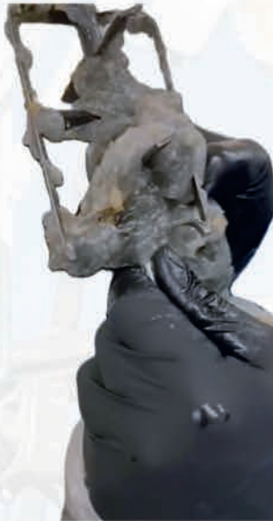
РИСУНОК 2. Нарушение целостности образца геля при использовании консистометра высокого давления и температуры Fann 422
