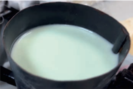
РИСУНОК 1. Внешний вид состава плотностью 1,05 г/см³ после отстоя 48 ч
