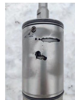
РИСУНОК 1. Износ стакана пульсатора
