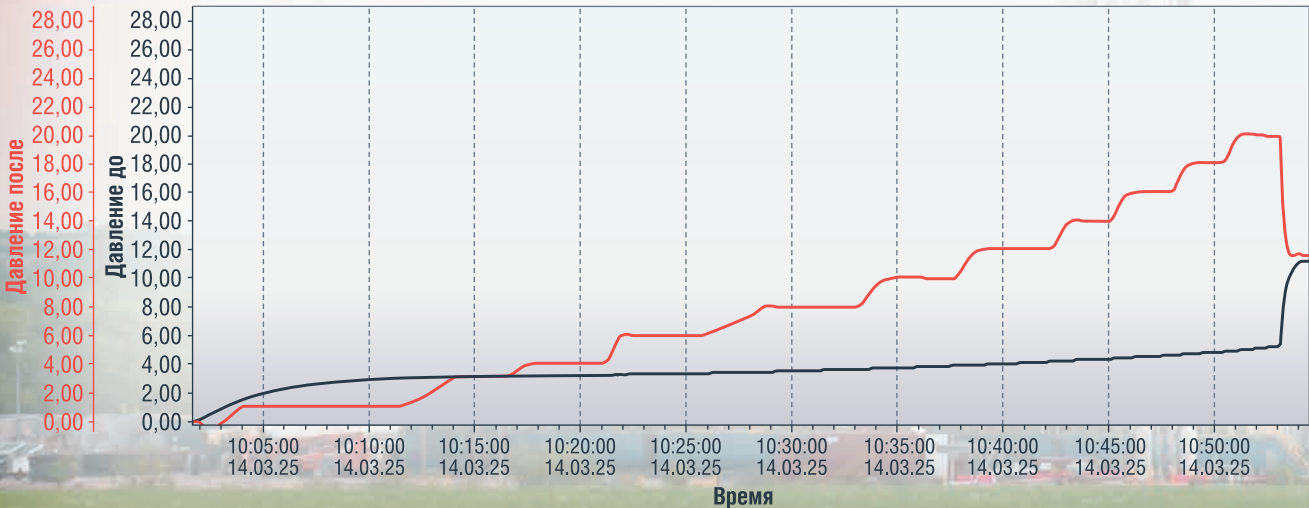
РИСУНОК 4. График проверки герметизации искусственного канала в ЦК с СВЦ
