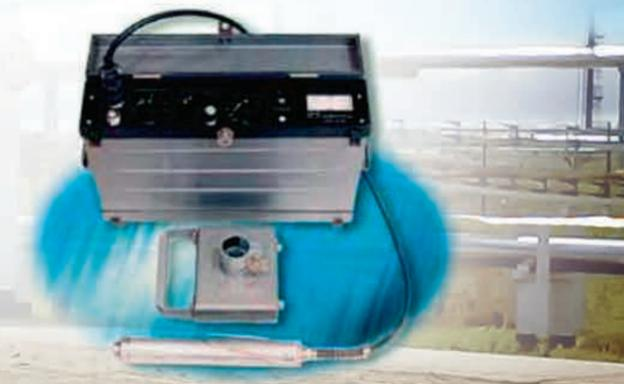
Его принцип действия основан на фиксировании акустического шума, возникающего при истечении жидкости через сквозную трещину. Он может находить подобные дефекты, находящиеся в воде на глубине до 30 метров. Несмотря на то, что коррозия трубы или различного рода вмятины и истончение стенок – неизбежный результат процесса перекачки, но с помощью течейскаателя можно вовремя обнаружить дефект, обеспечив своевременный ремонт.
