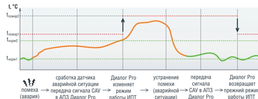
$t_{норм1}$ ,  $t_{норм2}$  – условно нормальная температура среды соответственно до возникновения помехи и после возникновения помехи;  $t_{пожар1}$ ,  $t_{пожар2}$  – температура срабатывания пожарного извещателя соответственно до возникновения помехи и после возникновения помехи; АПЗ – система автоматической противопожарной защиты; САУ – системами автоматического управления; ПАЗ – система противоаварийной защиты; ИПТ – извещатель пожарной тепловой
