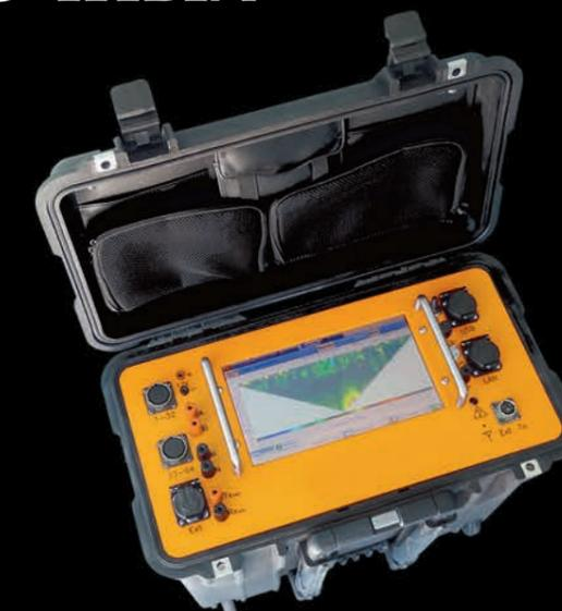
Аппаратурно-программный комплекс для выполнения электроразведочных работ методом сопротивлений, естественного поля, вызванной поляризации, диагностики трубопроводов, исследований электрохимзащиты и т.п. Это аппаратно-программный комплекс, позволяющий проводить электроразведку несколькими методами.
