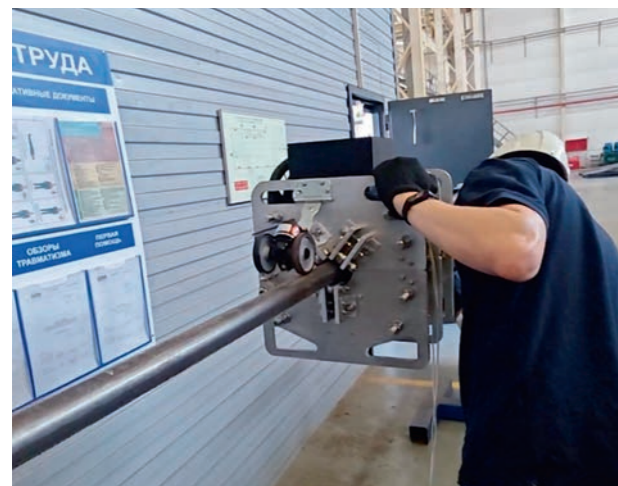
РИСУНОК 9. Тестирование на настроечном образце
