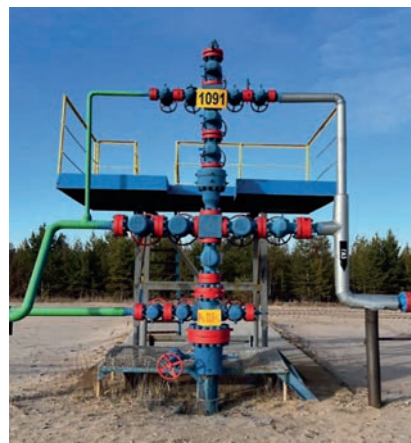
РИСУНОК 4. Фонтанная арматура скважины, оборудованной концентрической лифтовой колонной
