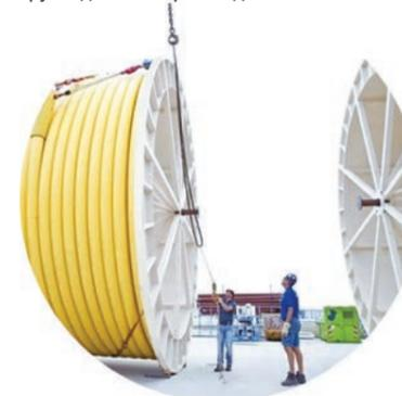
Термопластичные композитные трубы со сплошной стенкой из слоев полимерного наполнителя и матриц, армированных высокопрочными волокнами, позволяют выдерживать давление до 500 атмосфер на глубине до 400 метров.
