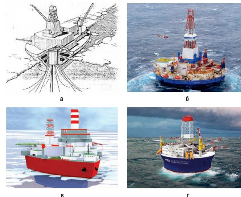
а – судно яйцеобразной формы; б – установка с корпусом в виде тела вращения (ЛПБУ «Kulluk»); в – ЛПБУ клиновидной формы (концепция ЛПБУ ЦКБ «Коралл»); г – установка с корпусом в виде тела вращения (ЛПБУ «Sevan»)
