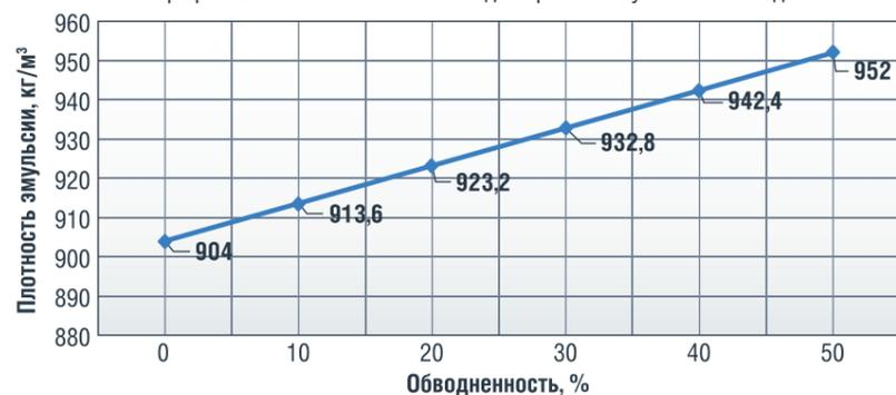
РИСУНОК 6. График зависимости плотности водонефтяной эмульсии от обводненности месторождения Зыбза-Глубокий Яр
