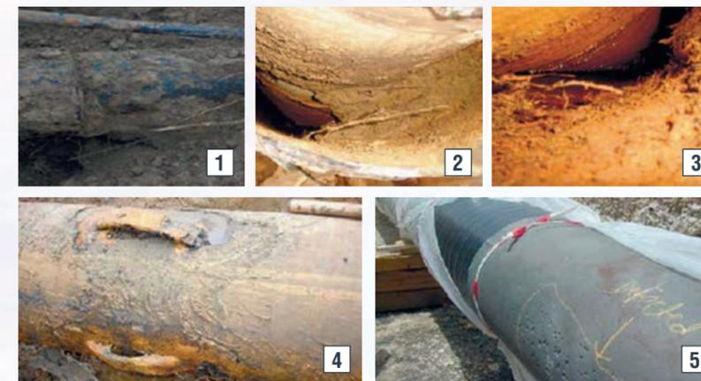
1 – пример незащищенного трубопровода; 2 – грязь, ржавчина внутри футляра; 3 – появление конденсата в футляре; 4 – металлические спейсеры, приваренные к трубе, образуют гальваническую пару с самого начала эксплуатации трубопровода; 5 – поверхность, дефекты в результате воздействия блуждающих токов
