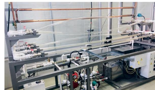
РИС. 2. Технологическая схема участков экспериментальной установки для изучения газожидкостного течения в горизонтальных трубах и трубопроводах, проложенных через возвышенности и низины местности
