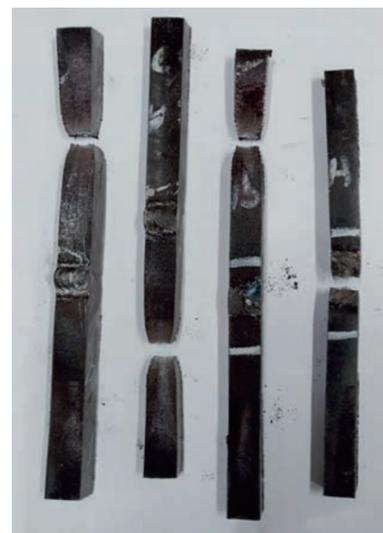
Для проведения испытаний на малоцикловую долговечность были выбраны пластины, имеющие единичные дефекты (непровар и подрез) и сочетание этих дефектов. Размеры дефектов приведены в таблице 2.
