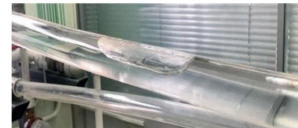
РИС. 5. Структурное течение многофазного потока на выпуклом участке с углом наклона трубы к горизонту на участке визуального наблюдения  $\alpha = 9^\circ$
