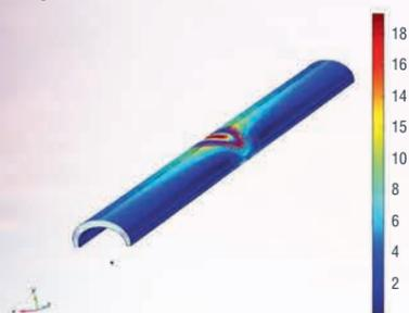
РИС. 11. Отображение полей скоростей газа (показана на цветовой шкале, м/с) в полости между трубопроводом и защитным кожухом
