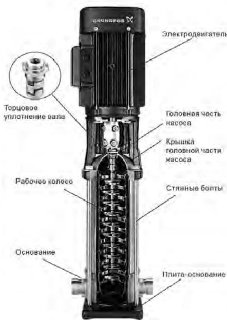
РИС. 4. ОБЩИЙ ВИД УСТАНОВКИ НАСОСА «ГРУНДФОС» ТИПА CR1 И CR1S.
