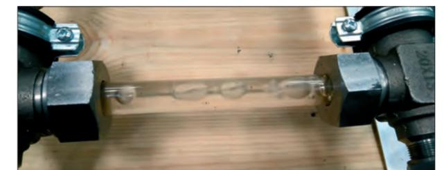
РИС. 12. СТРУКТУРА ВОДОГАЗОВОЙ СМЕСИ, ВЫХОДЯЩЕЙ ИЗ НАСОСА CR1S-30, ПРИ НЕПОДАВЛЕННОЙ КОАЛЕСЦЕНЦИЕЙ ГАЗОВЫХ ПУЗЫРЬКОВ (НАРУЖНЫЙ ДИАМЕТР СТЕКЛЯННОЙ ТРУБКИ СОСТАВЛЯЕТ 20 ММ).
