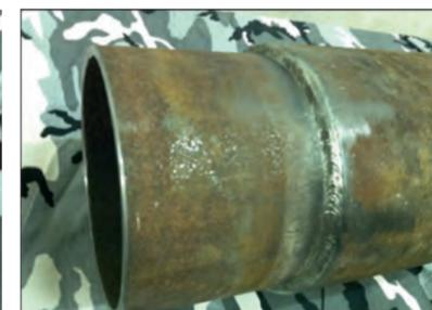
РИС. 3.2. Узел «муфта кондуктора – монтажный патрубок колонной головки» со сварным соединением, имитирующим ремонт узла для устранения негерметичности резьбового соединения
