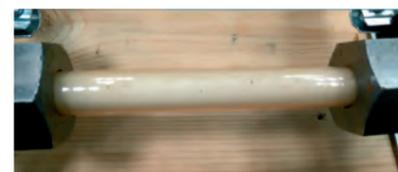
РИС. 18. СТРУКТУРА ВОДОГАЗОВОЙ СМЕСИ, ВЫХОДЯЩЕЙ ИЗ НАСОСА CR1S-30, ПРИ КОНЦЕНТРАЦИИ ХЛОРИСТОГО НАТРИЯ 6,62%.
