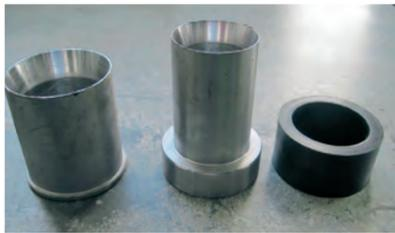
РИС. 13. КОМПЛЕКТ РЕЗЬБЫ ТРУБЫ ЗРТ-73 КОНСТРУКЦИИ БЕЛНИПИНЕФТЬ ДЛЯ ЗАЩИТЫ ОТ ЭРОЗИОННОЙ КОРРОЗИИ НИППЕЛЬНОЙ ЧАСТИ ТРУБЫ, УСТАНАВЛИВАЕМОЙ НАД ОБРАТНЫМ КЛАПАНОМ ЭЦН
