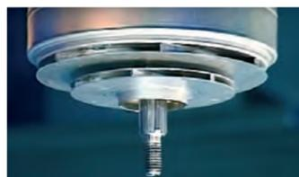
РИС. 6. ФОТОГРАФИЯ СТУПЕНИ НАСОСА «ГРУНДФОС» ТИПА CR1 И CR1S.
