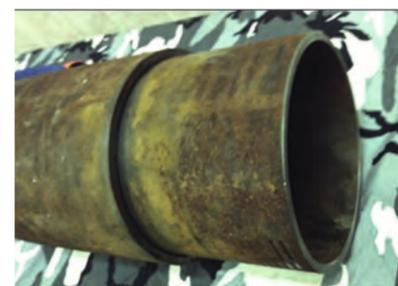
РИС. 3.1. Узел «муфта кондуктора – монтажный патрубок колонной головки» без сварного соединения
