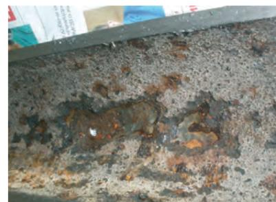
РИС. 9. ЭЛЕКТРОХИМИЧЕСКАЯ ЖИДКОСТНАЯ КОРРОЗИЯ НКТ ПР-ВА СИНАРСКОГО ТРУБНОГО ЗАВОДА, ПОДНЯТЫХ ИЗ СКВ.№128 ЮЖНО-ОСТАШКОВИЧСКОГО М-Я С НАРАБОТКОЙ 372 СУТОК
