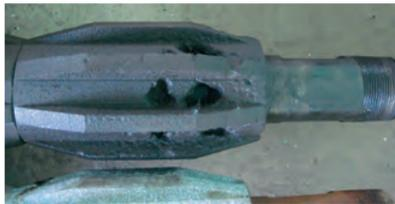
РИС. 14. ХАРАКТЕР ПОВРЕЖДЕНИЯ ПРОТЕКТОРА КОРРОЗИИ ПЭД, КОНСТРУКЦИИ БЕЛНИПИНЕФТЬ, ПОДНЯТОГО ИЗ СКВАЖИНЫ №103 Ю.СОСНОВСКОГО М-Я (ННО 410СУТ).
