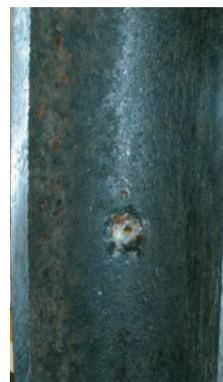
РИС. 10. ЭЛЕКТРОХИМИЧЕСКАЯ ЖИДКОСТНАЯ ИЗБИРАТЕЛЬНАЯ КОРРОЗИЯ НКТ ПР-ВА СИНАРСКОГО ТРУБНОГО ЗАВОДА, ПОДНЯТЫХ ИЗ СКВАЖИНЫ №62 ВИШАНСКОГО М-Я С НАРАБОТКОЙ 788 СУТОК
