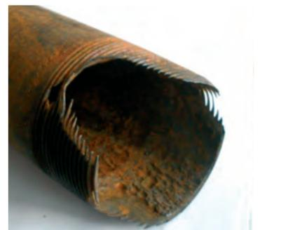
РИС. 11. ЭЛЕКТРОХИМИЧЕСКАЯ ЖИДКОСТНАЯ ЭРОЗИЯ НКТ ПР-ВА СИНАРСКОГО ТРУБНОГО ЗАВОДА, ПОДНЯТЫХ ИЗ СКВАЖИНЫ №149 ЮЖНО-СОСНОВСКОГО МЕСТОРОЖДЕНИЯ С НАРАБОТКОЙ 847 СУТОК
