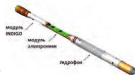
РИС. 1. Спектральный шумомер SNL
