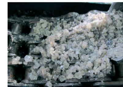
РИС. 4. ХЛОРИДНАЯ СОЛЬ, ОТОБРАННАЯ ИЗ ПОДЗЕМНОГО ОБОРУДОВАНИЯ УЭЦН-СКВАЖИНЫ №105 ОСТАШКОВИЧСКОГО МЕСТОРОЖДЕНИЯ.
