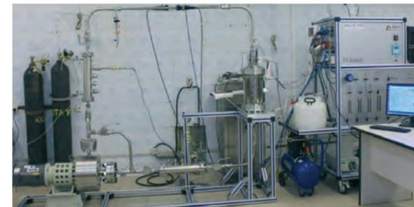
РИС. 15. СТЕНД ДЛЯ МОДЕЛИРОВАНИЯ И ИЗУЧЕНИЯ КОРРОЗИОННЫХ ПРОЦЕССОВ В СКВАЖИНЫХ УСЛОВИЯХ
