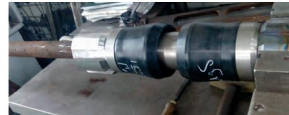
РИС. 16. УПЛОТНИТЕЛЬНЫЙ УЗЕЛ ФИЛЬТРА ФГК, ОБЕСПЕЧИВАЮЩИЙ ГЕРМЕТИЗАЦИЮ ЗАТРУБНОГО ПРОСТРАНСТВА СКВАЖИНЫ, ДЛЯ ЗАЩИТЫ УЭЦН ОТ МЕХАНИЧЕСКИХ ПРИМЕСЕЙ
