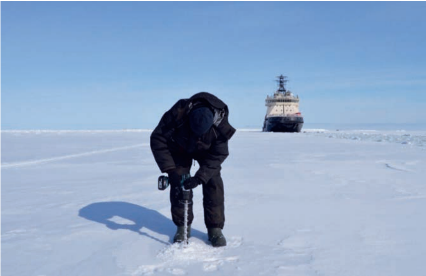
РИС. 6. Сквозное бурение ледяного покрова
