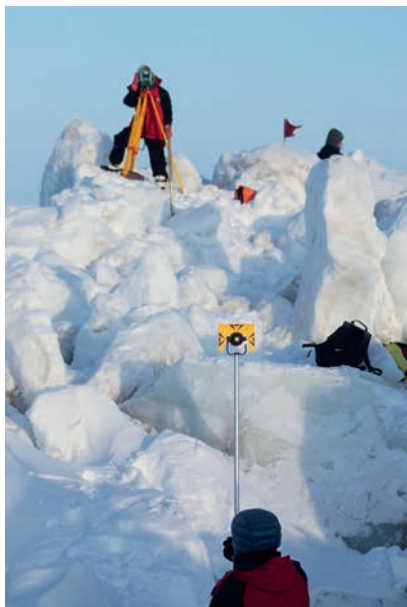
РИС. 7. Геодезическая привязка точек бурения
