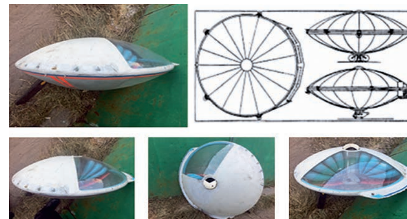
РИС. 4. Аэродинамические прототип-модели для экспериментальных исследований в МАИ
