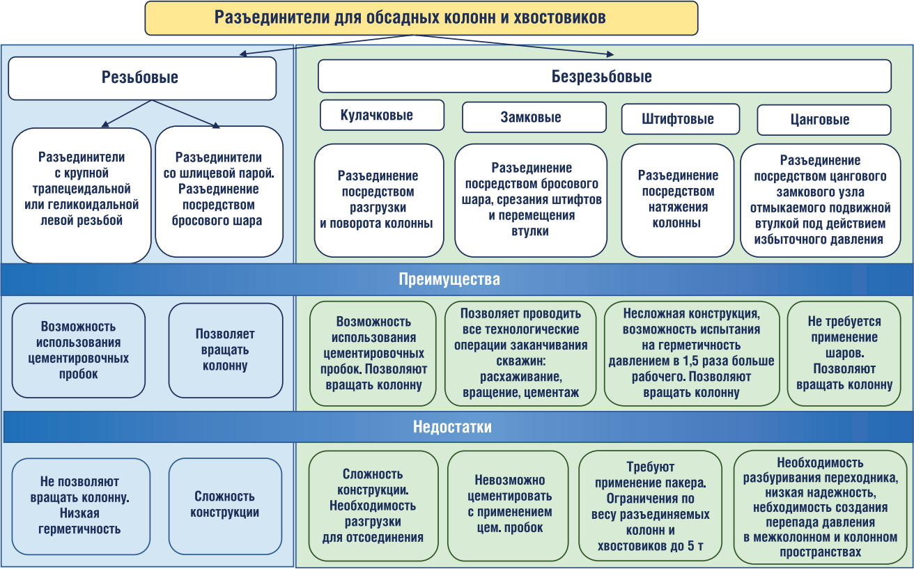
РИСУНОК 2. Классификация разъединителей для обсадных колонн и хвостовиков. Преимущества и недостатки
