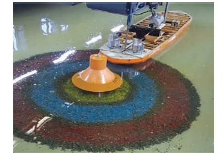
РИС. 6. Экспериментальные исследования по размыву грунта
