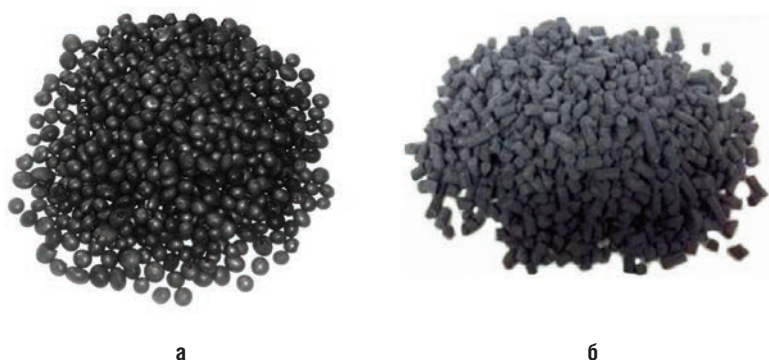
РИС. 4. а) Co-Al 2 O 3 /SiO 2 катализатор синтеза длинноцепочечных углеводородов; б) композитный Co/SiO 2 /HZSM-5 катализатор
