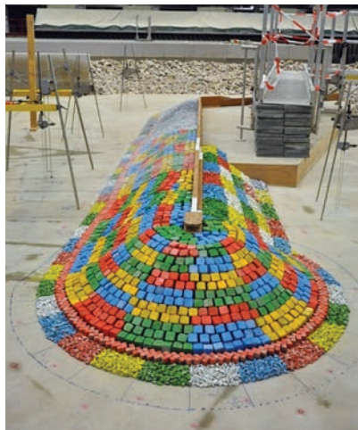
РИС. 3. Определение устойчивости элементов насыпной конструкции в бассейне
