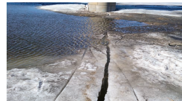
РИС. 7. Разрушение затопленного водой льда
