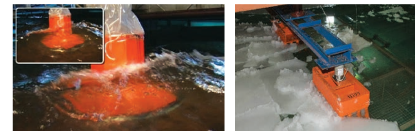
РИС. 2. Физическое моделирование воздействия волнения и льда на ГТС
