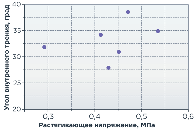
РИСУНОК 2. Угол внутреннего трения образцов песчаника тульского горизонта Карашурского ПХГ из скважины Ка
