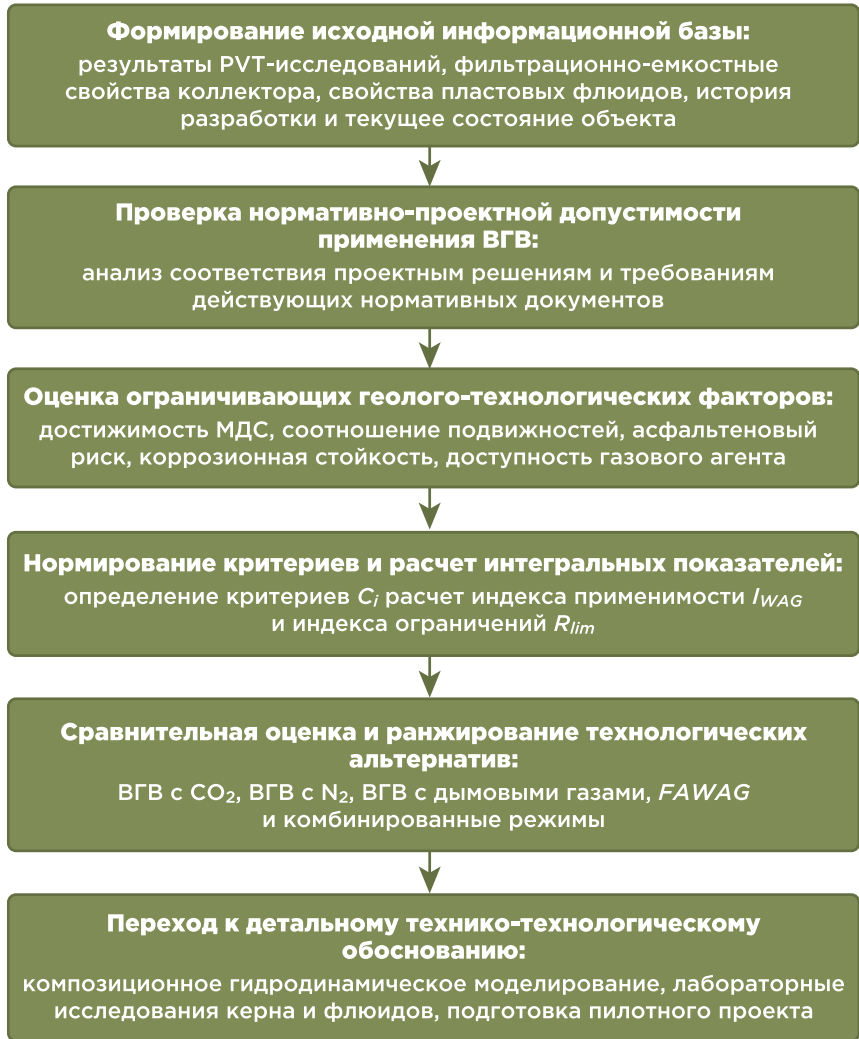
РИСУНОК 2. Алгоритм предварительной оценки применимости ВГВ с неуглеводородными газами на основе критерия I_{WAG}
