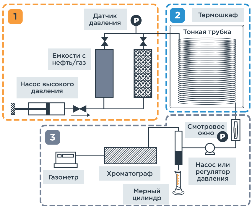
РИСУНОК 2. Принципиальная схема изучения многоконтактной смесимости («тонкая трубка»)
