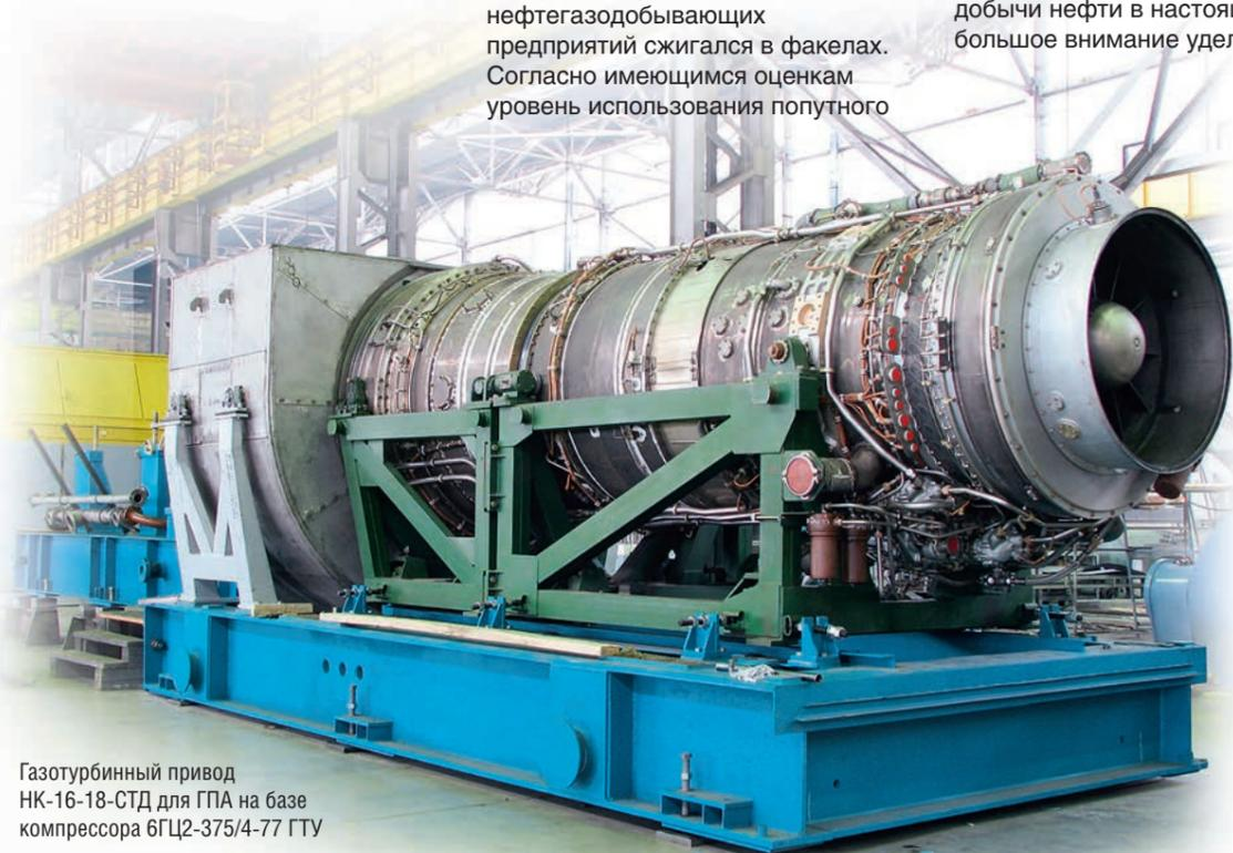
Газотурбинный привод НК-16-18-СТД для ГПА на базе компрессора 6ГЦ2-375/4-77 ГТУ
