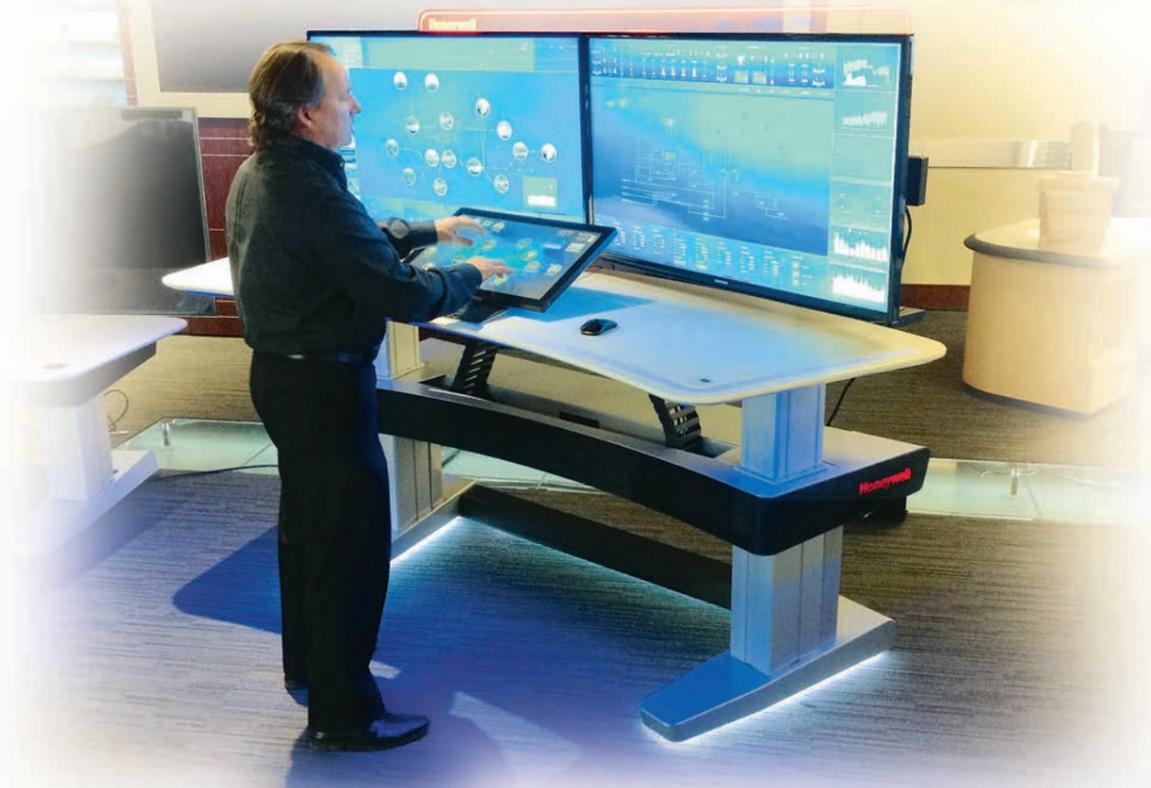
Консоль **Experion® Orion**, созданная на основе флагманской платформы компании Honeywell Experion Process Knowledge System (PKS), сочетает в себе эргономичный дизайн и улучшенный человеко-машинный интерфейс, что даёт возможность упростить работу с системами управления, снизить утомляемость операторов и повысить эффективность контроля над ситуацией.
