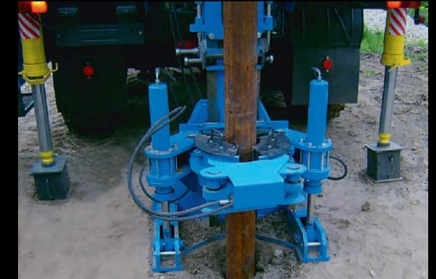
Буровые установки серии УГБ-001 комплектуются гидроприводным обсадным столом, который предназначен для осаживания, фиксации и извлечения обсадных колонн при сооружении, ремонте и ликвидации скважин различного назначения глубиной до 200 метров.
