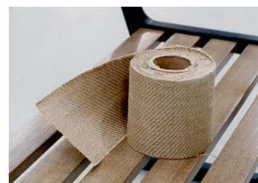
Сырье поступает на завод Татнефть-Пресскомпозит в виде ткани, из которой изготавливаются профили серии Есо. В изготовлении композитной продукции лен заменяет стекломатериал до 5%, и эта доля будет увеличиваться.
