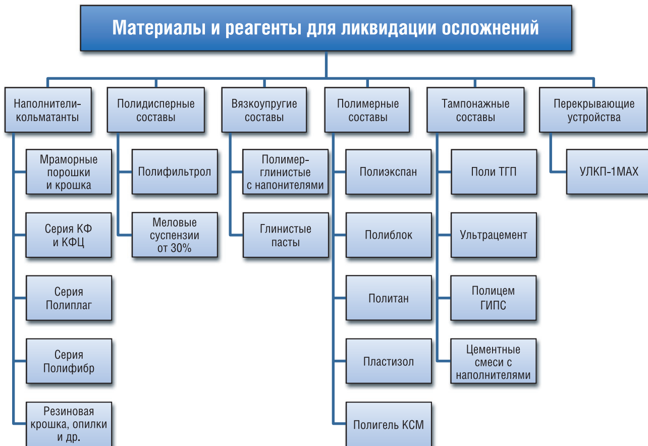
РИС. 3. Перечень материалов, реагентов и технологий для предупреждения и ликвидации поглощений при бурении и ремонте скважин
