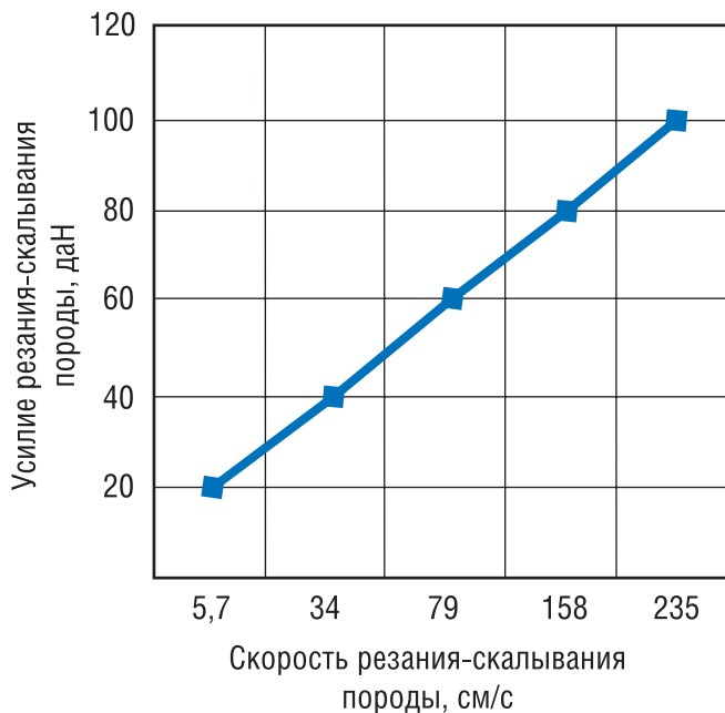
РИС. 5. Экспериментальная зависимость усилия резания-скалывания породы от скорости резания-скалывания
