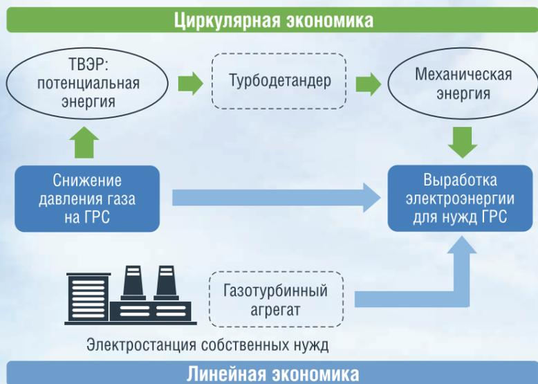
в разнице давления при распределении газа к конечным потребителям. Высокое давление, обеспечиваемое компрессорными станциями для передачи газа по трубопроводу, снижается на газораспределительных станциях (ГРС) и газораспределительных пунктах, откуда направляется к потребителю. Значительный потенциал применения вторичных энергетических ресурсов может быть использован на газораспределительных станциях, планируемых к строительству на Дальнем Востоке.
