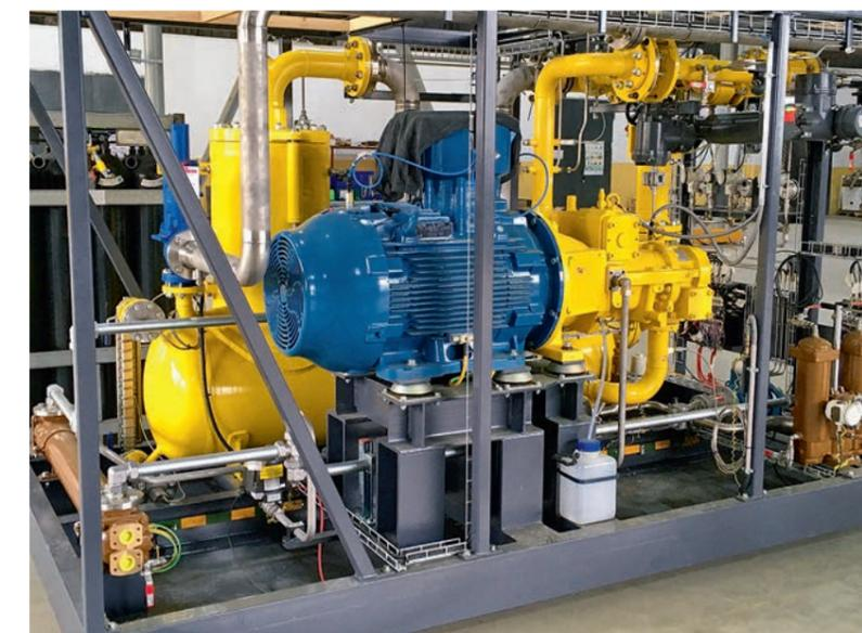
ФОТО 8. Установка рекуперации отпарного газа выполнена на базе компрессорных технологий
