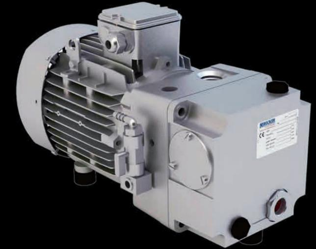
Пластинчатый вакуумный насос относится к насосам роторного типа, который сжимает откачиваемую воздушную смесь посредством изменения объема рабочей камеры.
