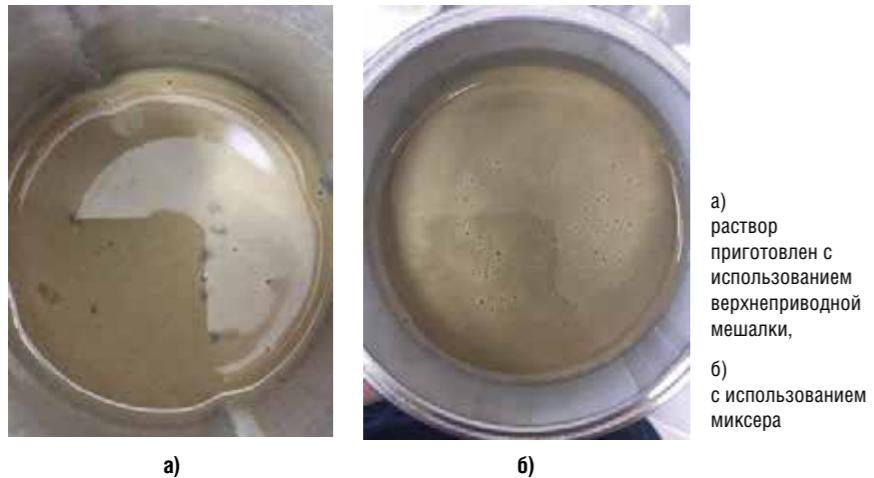
Механизм растворения полимерных материалов состоит из двух процессов: диффундирование молекул растворителя в поверхностный слой полимера и «распутывание» его цепей. В результате образуется слоистая структура, условно подразделяемая на следующие виды слоев: слой чистого полимера, слой инфильтрации, слой твердого набухшего полимера, гелеобразный слой, слой перешедшего в раствор полимера и чистый полимер (рисунок 3) [5].
