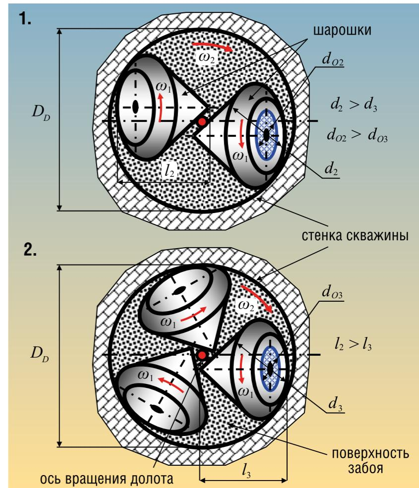
вооружением, увеличенная толщина стенок шарошек, кроме обеспечения увеличенных габаритов опоры, позволяет разместить и закрепить путем запрессовки или пайки твердосплавные зубки увеличенных габаритов, обладающих повышенной стойкостью по сравнению с твердосплавными зубками меньшего размера, используемых при оснащении аналогичных по диаметру трехшарошечных долот.
