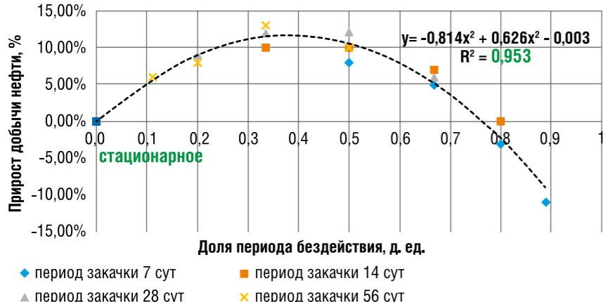
РИС. 8. Зависимость снижения ВНФ от доли периода бездействия
