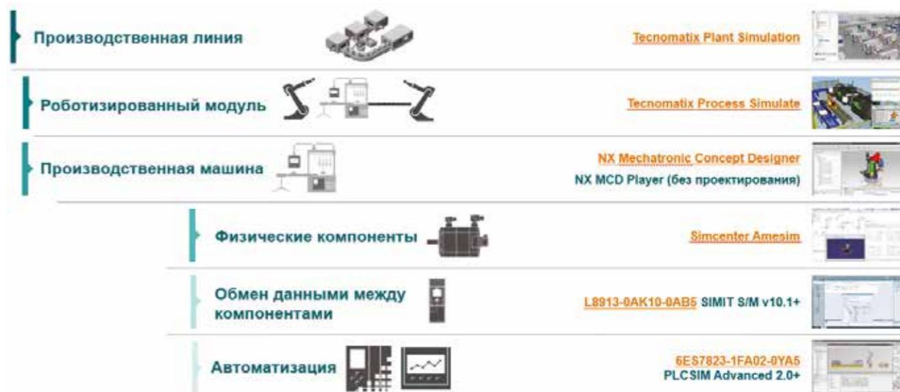
автоматизации, требуется всего лишь выбрать из списка доступных подключений необходимую систему симуляции, например SIMIT или PLCSIM Advanced, связать переменные и цифровой двойник уже готов работать с виртуальной системой АСУ ТП и включает в себя все те положительные опции, которые имеются в подсоединеных системах симуляции. При этом опускается использование виртуальных датчиков, как аналоговых, так и дискретных, скриптов тестирования и т.д. [4].
