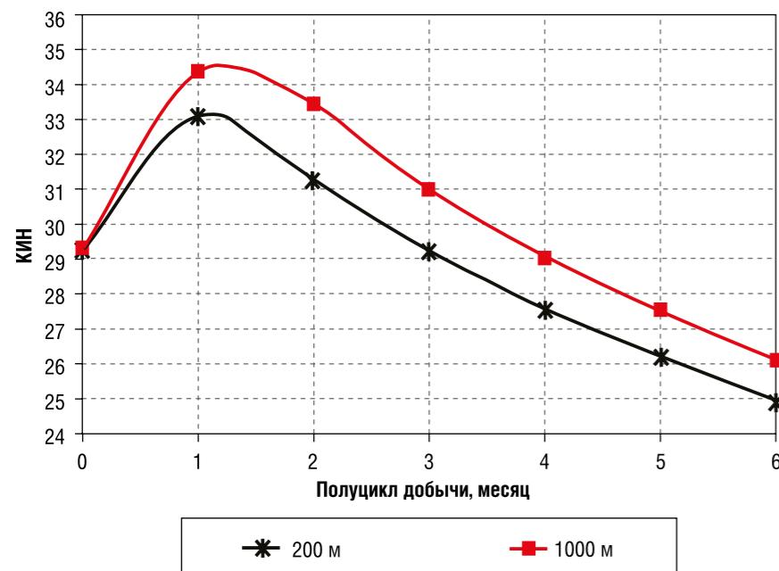
низкопроницаемого карбонатного коллектора при одинаковой продолжительности полуциклов. При этом с увеличением длины горизонтального участка эффективность нефтеизвлечения возрастает, в то время как для высокопроницаемого коллектора при увеличении длины горизонтальных скважин эффективность нефтеизвлечения снижается вследствие обводнения продукции ГС по трещинам.
