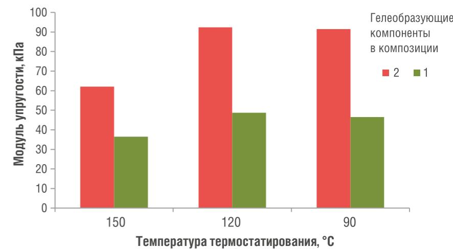
433–844 и 378–427 Па соответственно, значения модулей упругости комбинированных гелей также значительно выше. Для гелей, полученных из композиций на основе ЭЦ с одним полимерным гелеобразующим компонентом, предельное напряжение сдвига составляет 109–321 Па.
