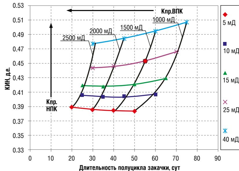
ТАБЛИЦА 2. Зависимость КИН за расчетный период от продолжительности полуцикла падения пластового давления
