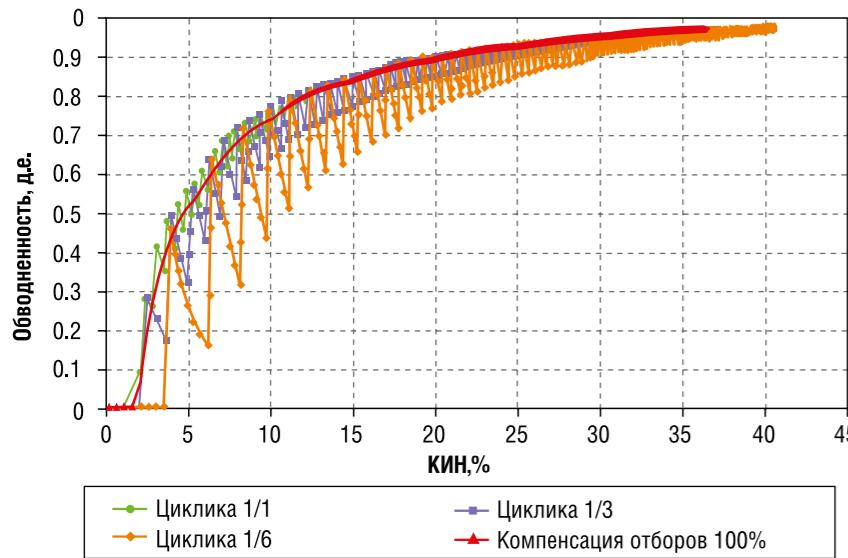
РИС. 3. Характеристики вытеснения «Накопленная добыча нефти – накопленная добыча жидкости» при циклическом и стационарном заводнении
