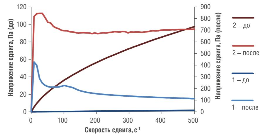
РИС. 4. Значения модуля упругости гелей, полученных из композиций с двумя (2) и одним (1) гелеобразующими компонентами после термостатирования при 90–150 °C
