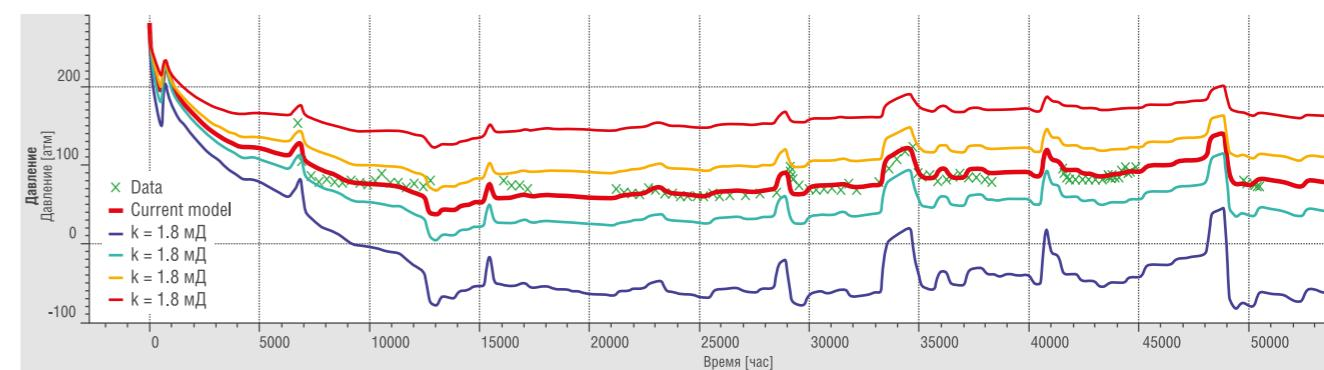
РИС. 4. Анализ чувствительности для аналитической модели на основе фактических данных работы скв. 100Г (расстояние до границы)
