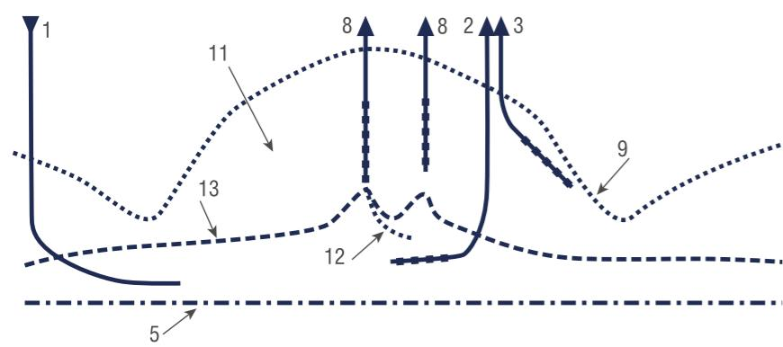
вертикальных добывающих скважин, в первоочередных скважинах-кандидатах на обводнение интервалы перфорации сокращают на 5–10 метров за счет цементирования их нижней части.
