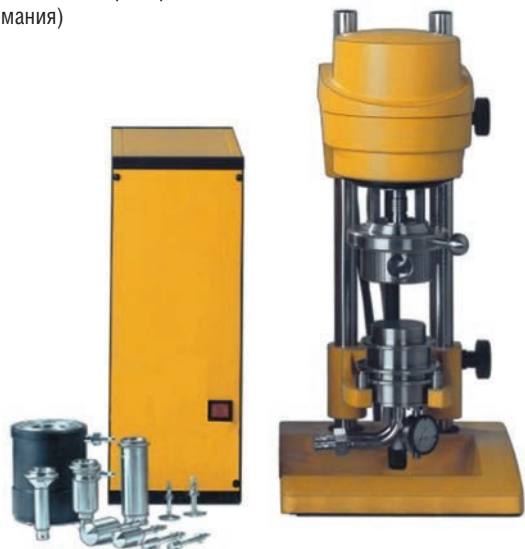
РИСУНОК 2. Прибор Rheotest RN4.1 (Германия)
