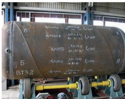
Рис. 4. Подготовка образца трубы к испытанию
