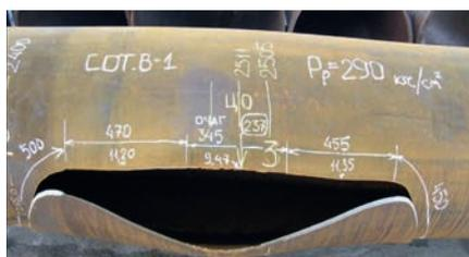
Рис. 5. Общий вид разрушенной трубы после испытания
