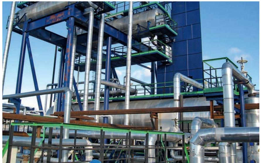
Фото 1. Разделительные сепараторы на установке подготовки нефти
