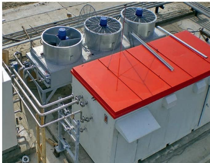
Фото 4. Адсорбционный осушитель для дополнительной осушки попутного газа на ЦПС Западно-Могутлорского месторождения ОАО «Аганнефтегазгеология»
